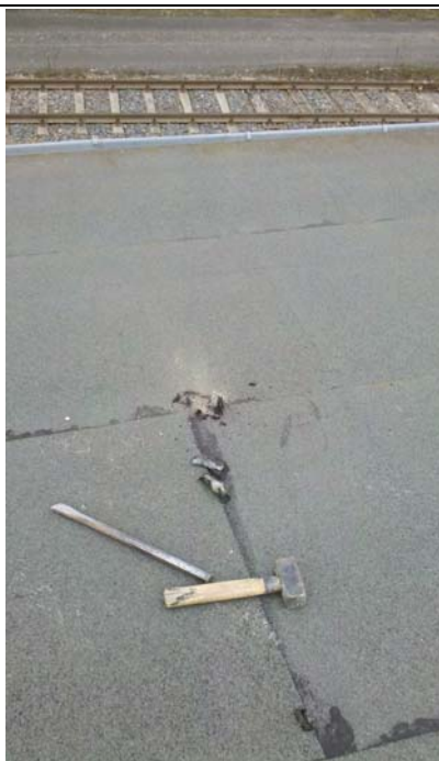
Probenahme Dachpappe Trafogebäude
