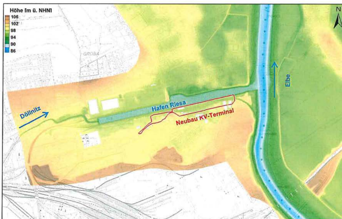
Abbildung 2-1: Höhendarstellung im hydraulischen Modell (Istzustand nach Einarbeitung der Bestandsvermessung /1/ und Planzustand /2/)
