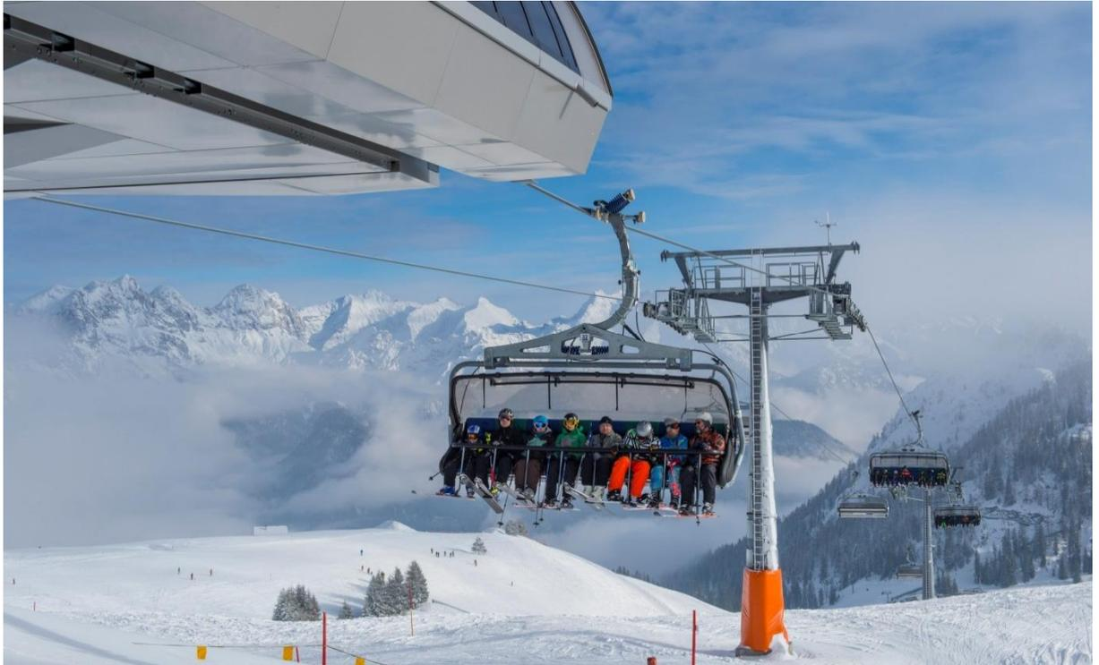
Abbildung 14: Achtersesselbahn mit Haube und Kindersicherung (Fa. Doppelmayr)
