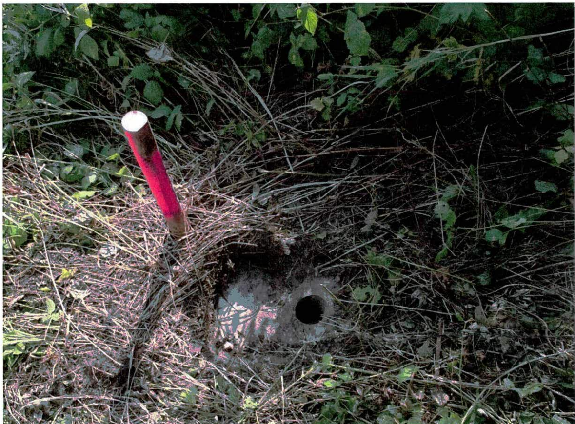
Bild 34: Rammsondierung DPH 175, Durchbohrte Sandstein-Deckung
