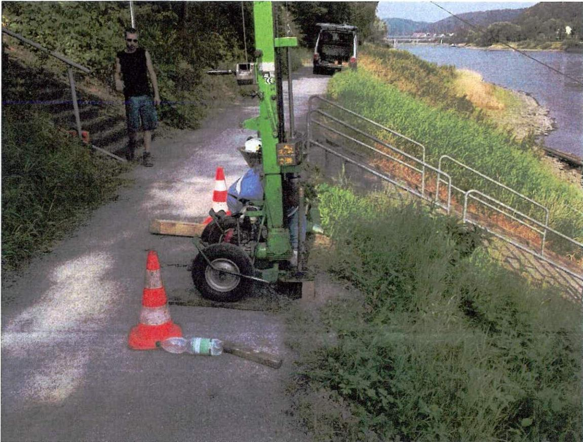
Bild 33: Schwere Rammsondierung DPH 165
