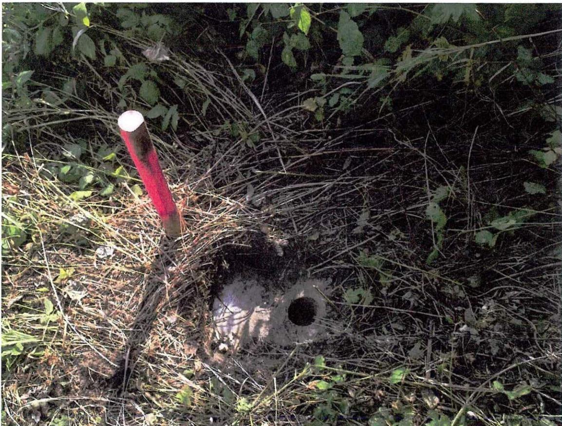
Bild 34: Rammsondierung DPH 175, Durchbohrte Sandstein-Deckung
