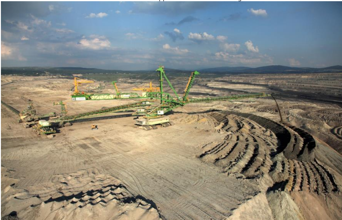
Foto 1. Absetzer bei der Arbeit auf der internen Kipphalde im Braunkohletagebau Turów
