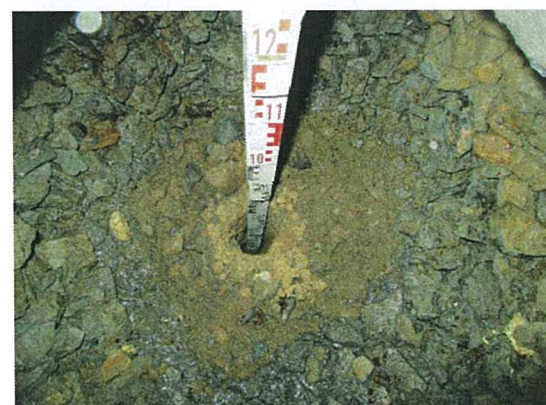
Bild 5: Handschurf und KRB 4 im Gleiskörper
