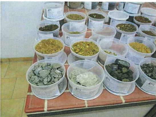
Bild 11: Probegutachtung - Mischprobenerstellung
