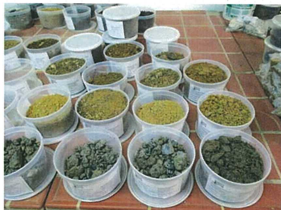
Bild 10: Probegutachtung - Mischprobenerstellung
