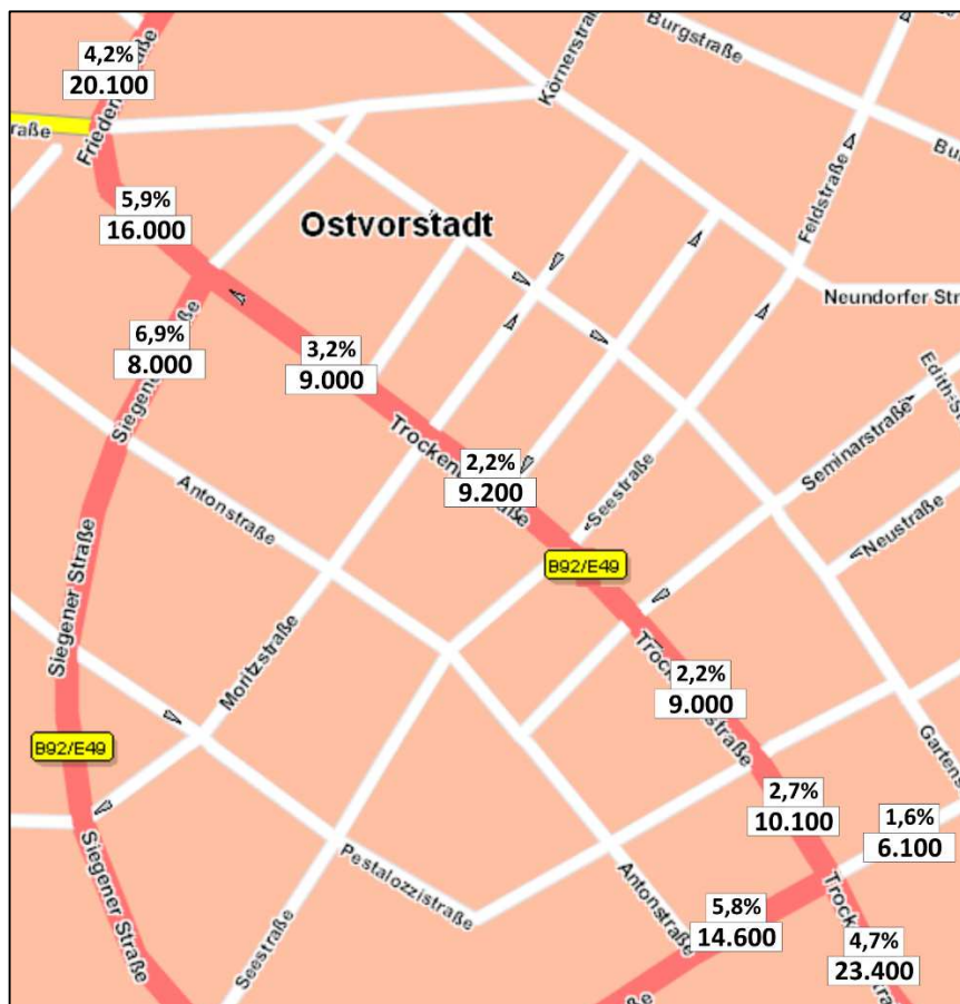
Abbildung 2: Analysebelastungen (DTV w5 und SV-Anteile)
