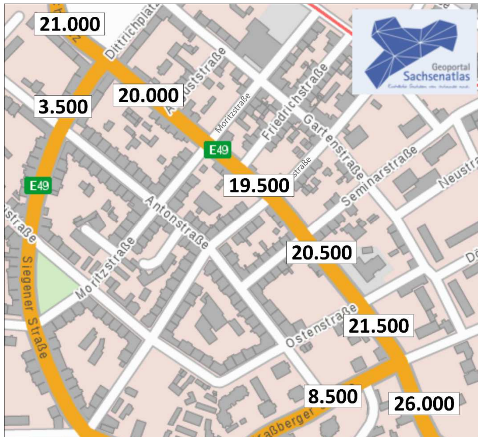
Abbildung 9: Prognosebelastungen 2030 - Planfall (DTV W5 in Kfz/24h)
