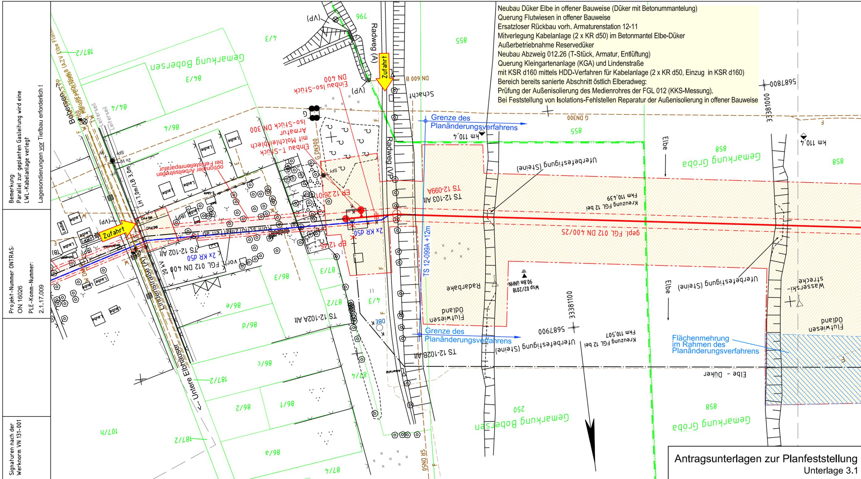
Neubau Düker Elbe in offener Bauweise (Düker mit Betonummantelung)
