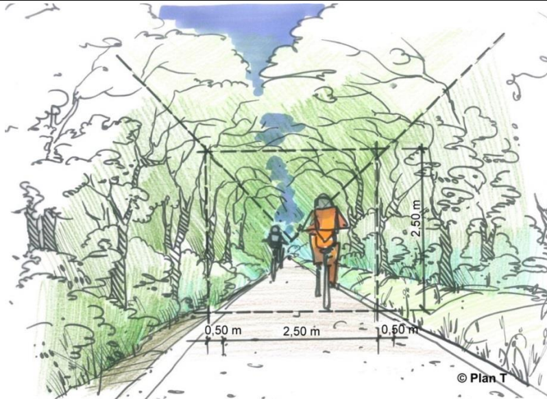
Abbildung 10: Prinzipische Skizze des empfohlenen Regelquerschnitts von Radwegen auf ehemaligen Bahntrassen. Die vorhandenen Gehölze auf der Böschung des Bahndammes schirmen Radfahrer und Erholungssuchende optisch ab.
