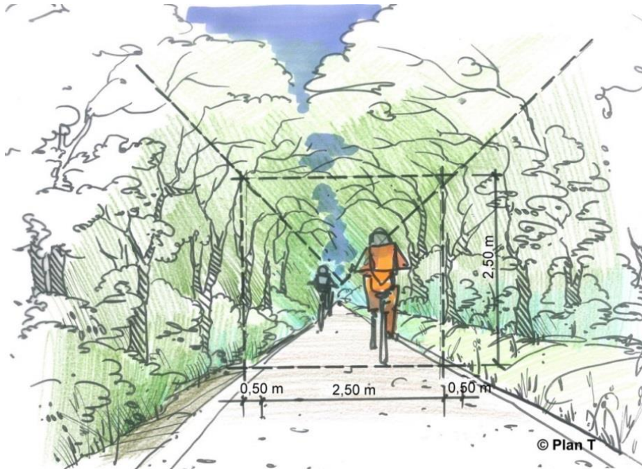
Abbildung 15: Prinzipiskezze des empfohlenen Regelquerschnitts von Radwegen auf ehemaligen Bahtrassen
