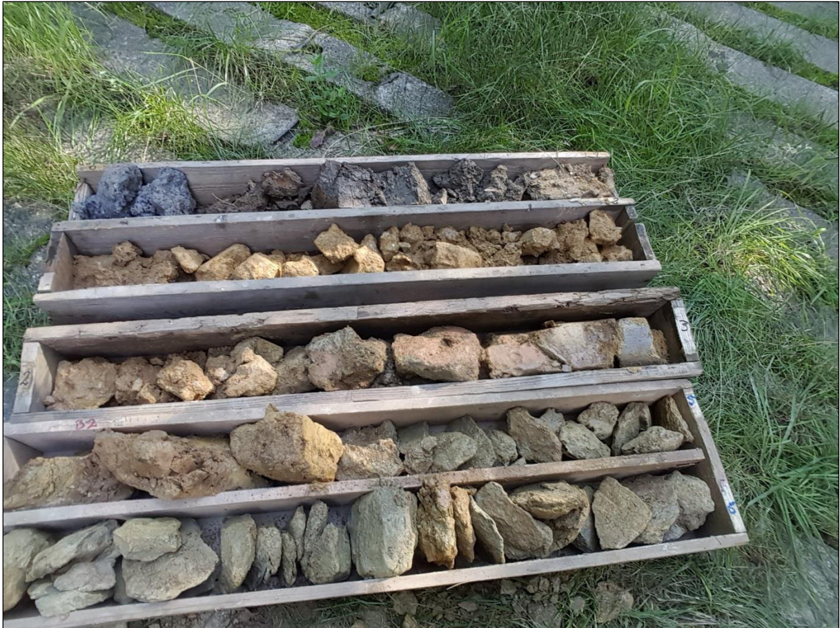
Schichtenfolge der Grundwassermessstelle GWM 5
