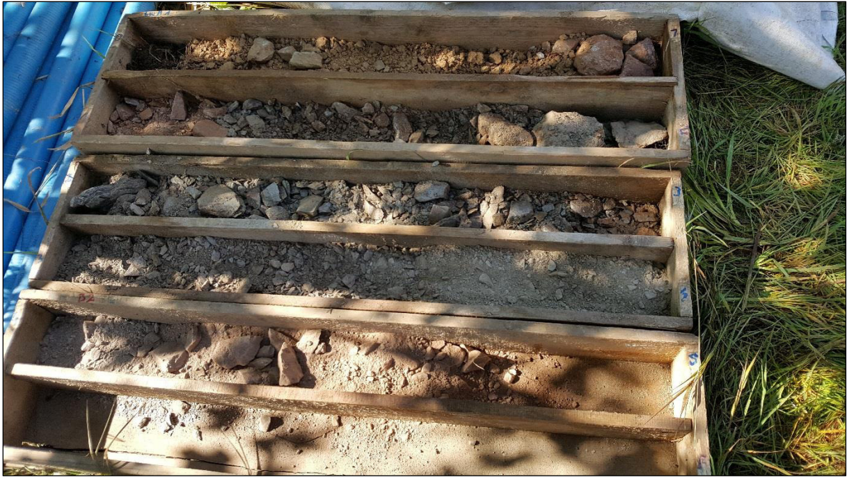
Schichtenfolge der Grundwassermessstelle GWM 2
