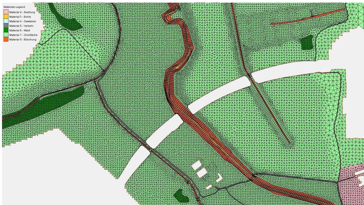
Abbildung 3: Modifizierung des Berechnungsnetzes im Bereich der Wyhra-Querung
