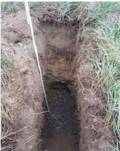
Foto 15: Schurf SG 7/19 (Tiefe bis 1,20 m)
