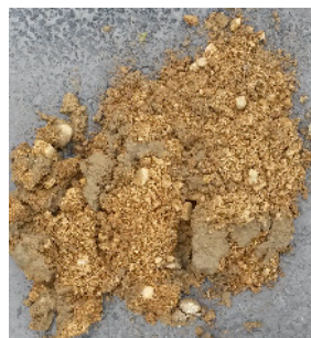
Foto 2: Aushub Kiestragschicht (Tiefe 0,28-0,40 m)
