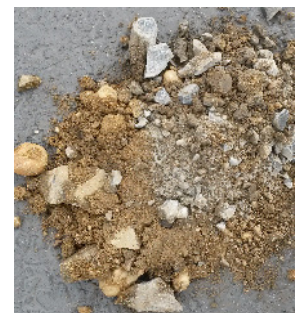
Foto 3: Aushub Tragschichtmaterial (Tiefe 0,40-0,50 m)
