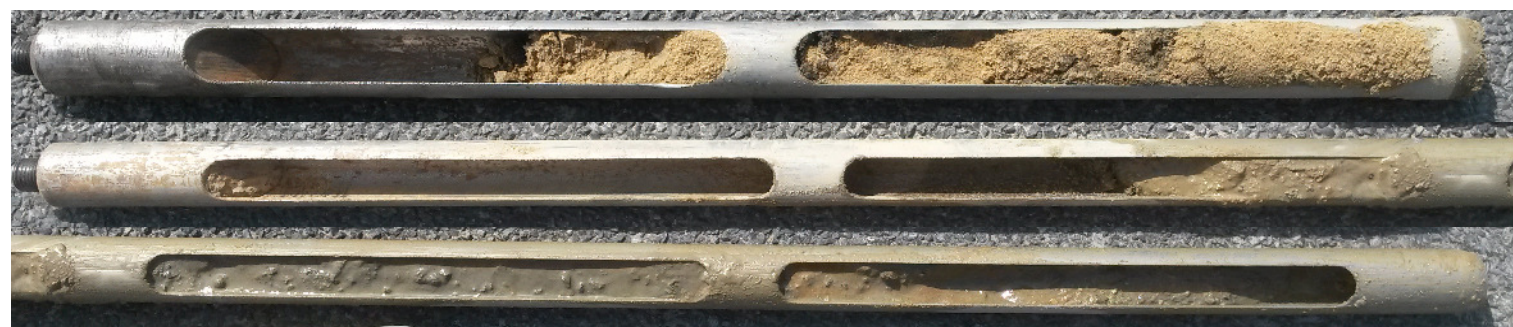
Foto 3: Baugrundsichtung von 0,48-3,00 m Tiefe
