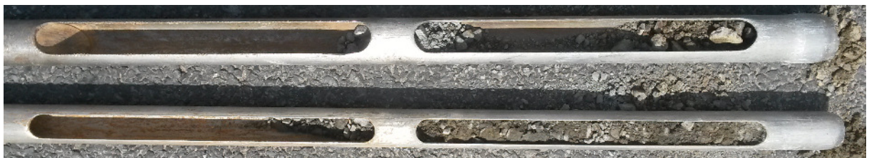
Foto 3: Baugrundsichtung von 1,50 m Tiefe
