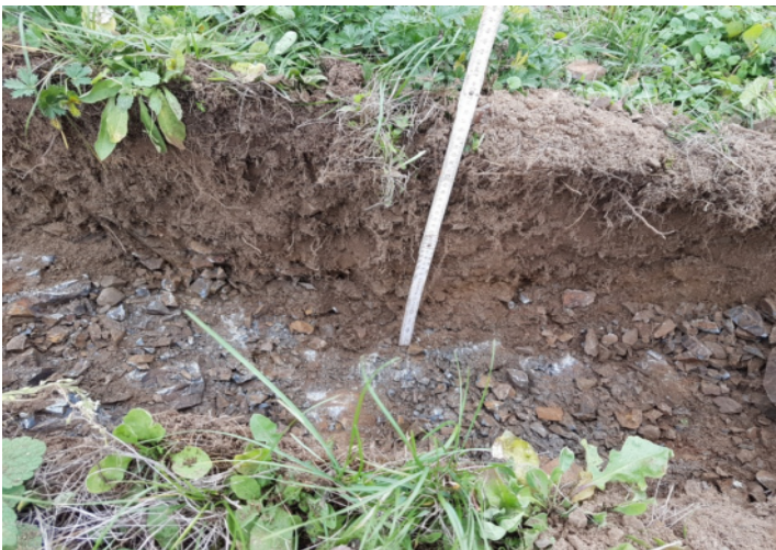
Foto 11: Schurf SG 5/19 (Tiefe bis 0,40 m)
