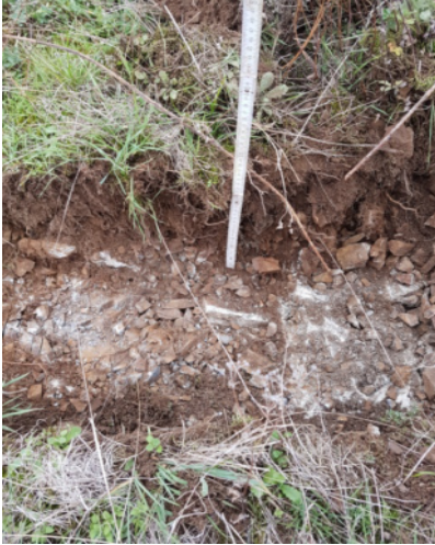
Foto 17: Schurf SG 8/19 (Tiefe bis 0,30 m)
