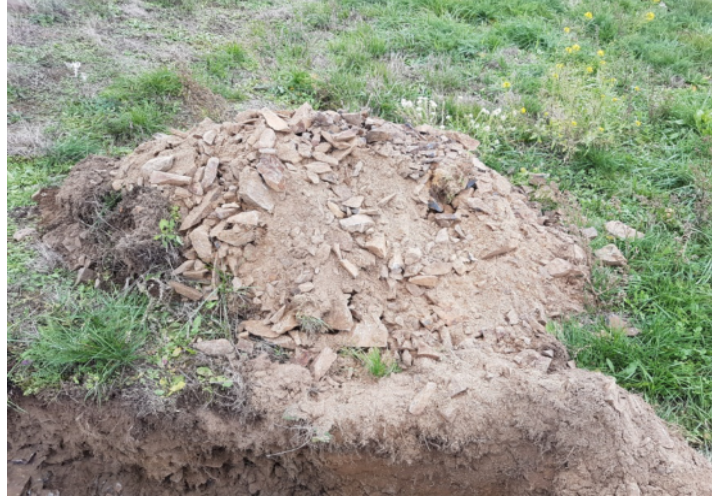
Foto 14: Aushub - Grauwackezersatz (0,05-0,60 m)
