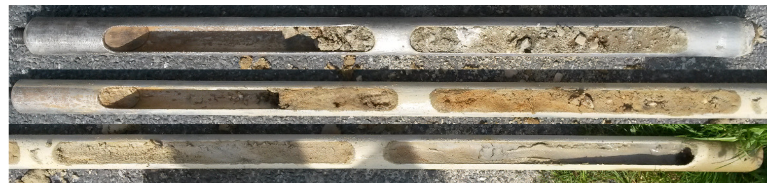
Foto 3: Baugrundsichtungung von 0,28-3,00 m Tiefe
