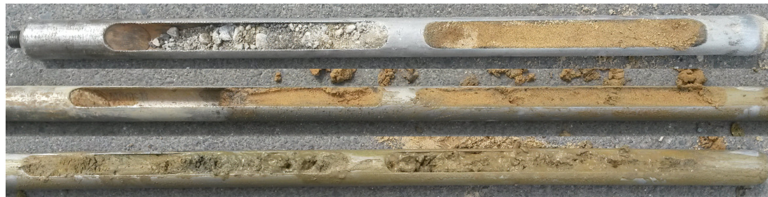
Foto 2: Baugrundsichtung von 0,15-2,90 m Tiefe
