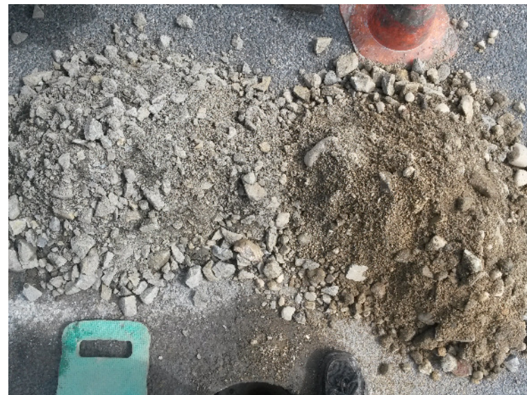
Foto 2: Aushubmaterial Tragschicht (links), Auffüllung (rechts)
