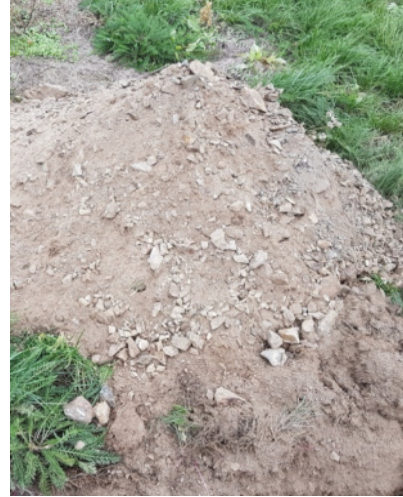
Foto 10: Aushub - Grauwackezersatz (0,20-0,50 m)
