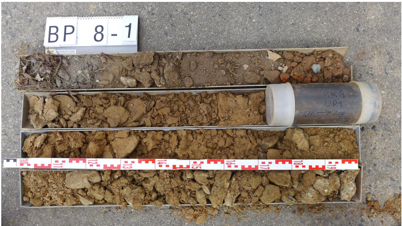
Bohrung BP8 (Radweg) 0,0 - 4,0 m, ungestörte Probe bei 1,7 m
