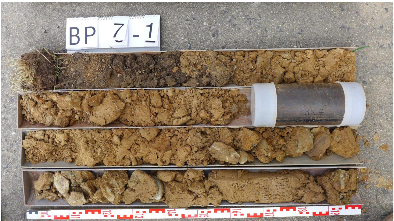
Bohrung BP7 (Radweg) 0,0 - 4,0 m, ungestörte Probe bei 1,7 m
