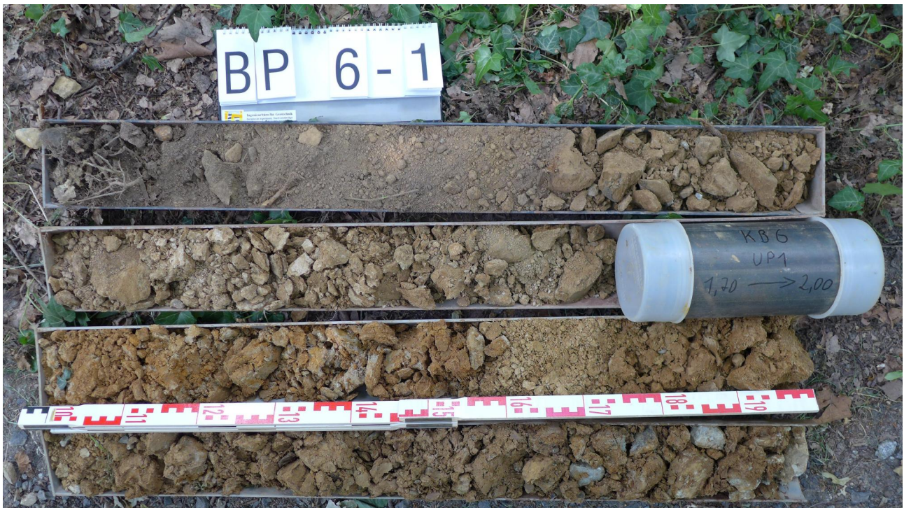
Bohrung BP6 (Radweg) 0,0 - 4,0 m, ungestörte Probe bei 1,7 m
