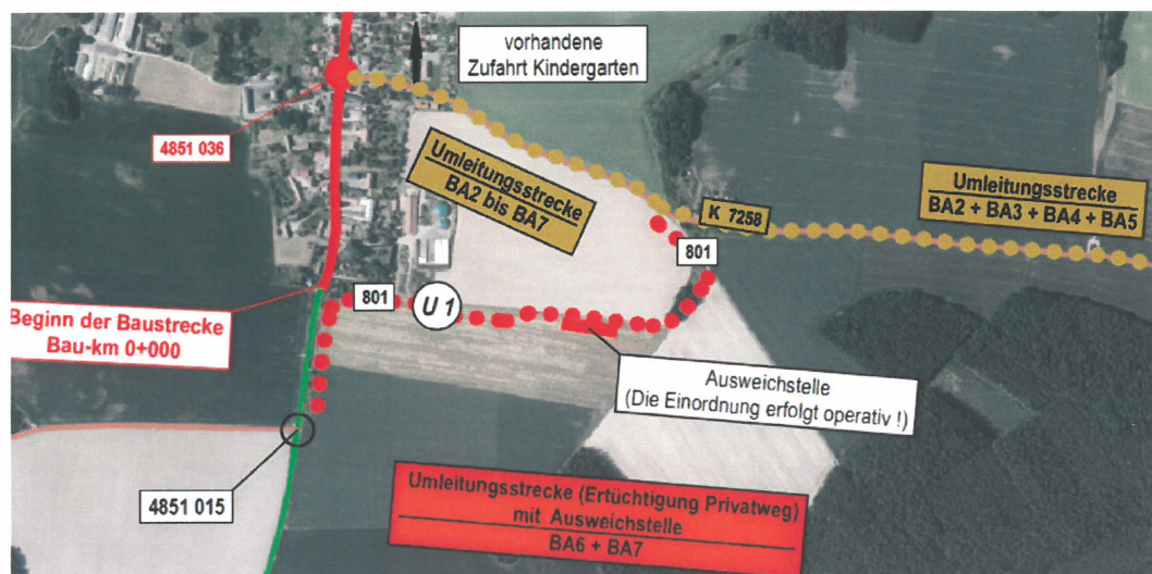
Auszug aus Plan 16.4.3 kleinräumige Umleitung, erstellt von AIB, 15.08.16
