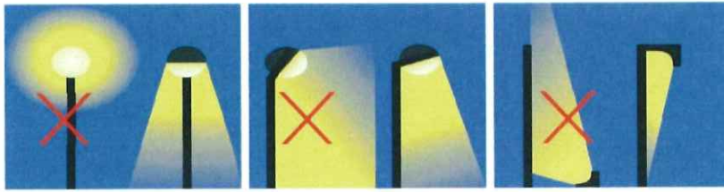
Abbildung 6: Maßnahmen zur punktuellen Beleuchtung von Baustellen (aus SCHMID et al. 2012) (die jeweils rechten Darstellungen entsprechen den Empfehlungen).
