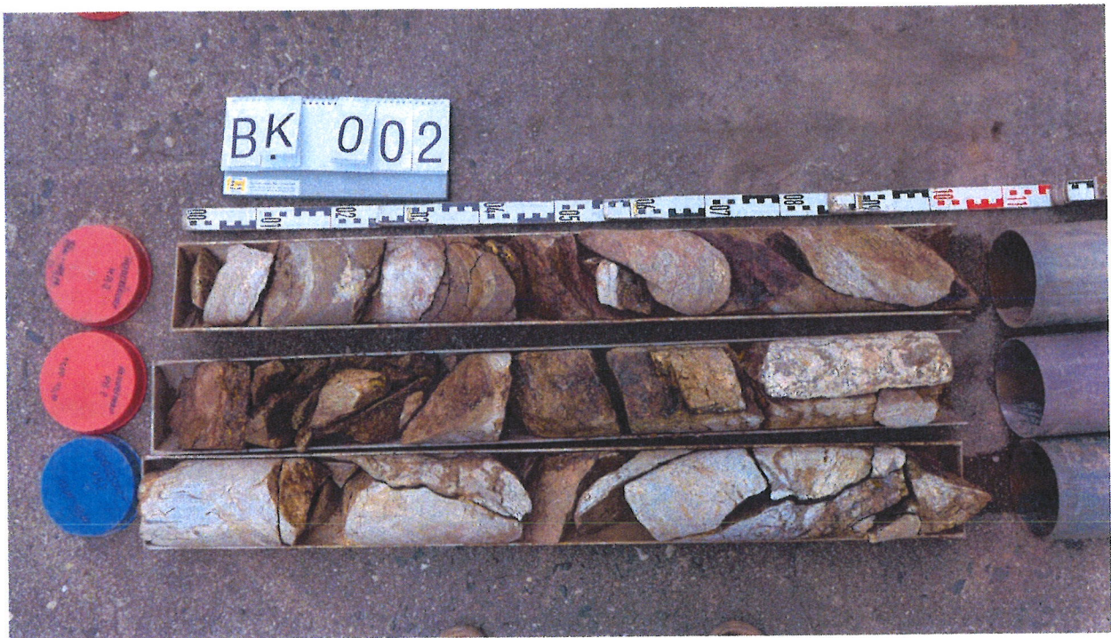
Bild 7: BK 2 (Widerlager Neuhausen) - Bohrmeter 10 bis 13
