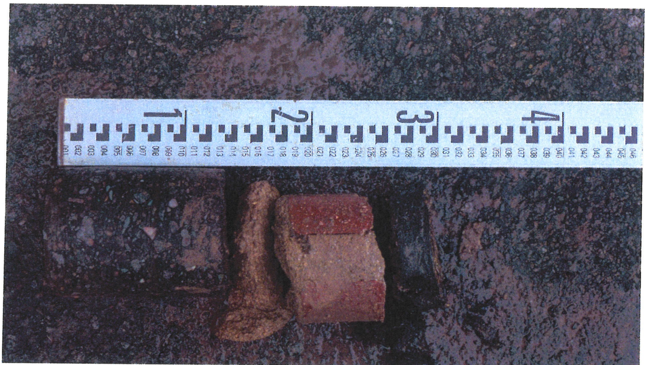
Bild 10: Überbau - Untersuchung Bauwerksdichtung: 13 cm Asphalt, 7 cm Beton, 7 cm Ziegel, 3 cm Teerdichtung
