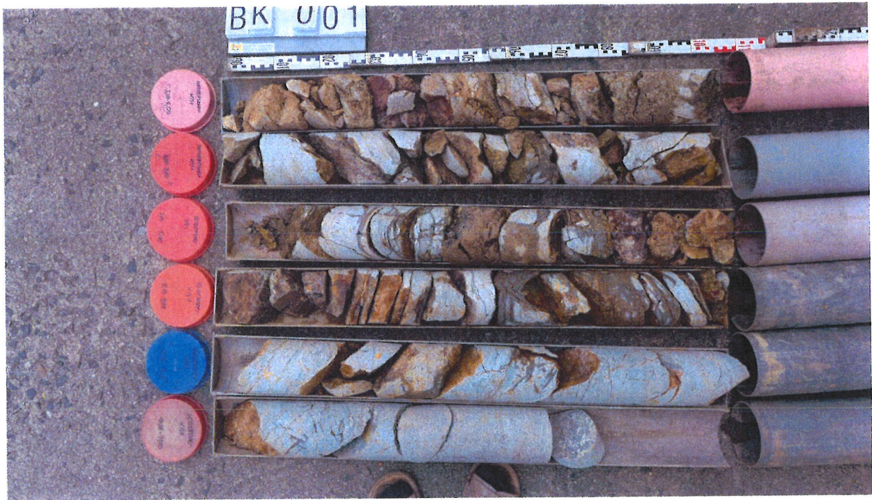
Bild 3: BK 1 (Widerlager Heidersdorf) - Bohrmeter 5 bis 11 (Endteufe)
