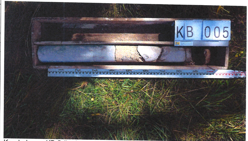
Kernbohrung KB 5 (horizontal) – Stärke der Flügelmauer: 0,86 m, Rückseite mit 13° abgeschrägt, nach unten verbreiternd Ansatzhöhe: 503,92 m NHN
