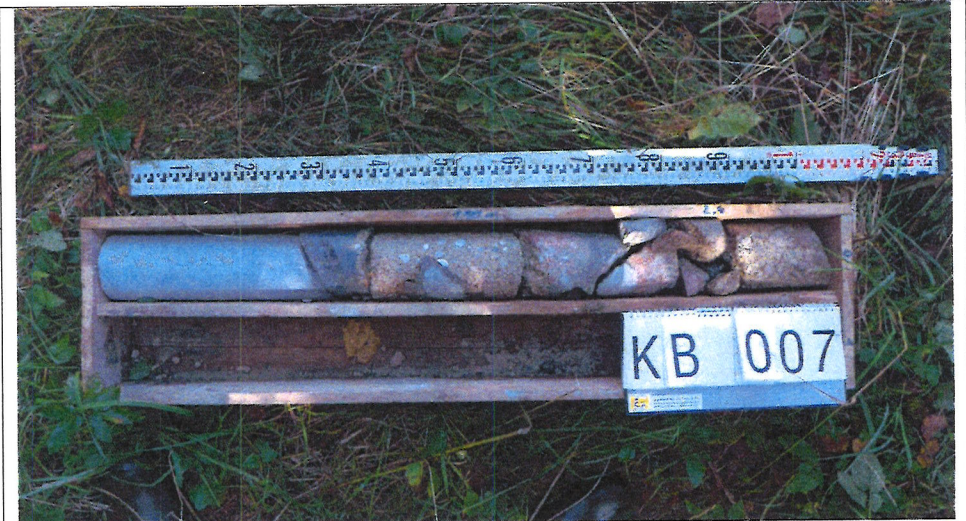
Kernbohrung KB 7 (horizontal) – Stärke der Flügelmauer: 1,0 m, Rückseite mit 13° abgeschrägt, nach unten verbreiternd, Ansatzhöhe: 503,50 m NHN
