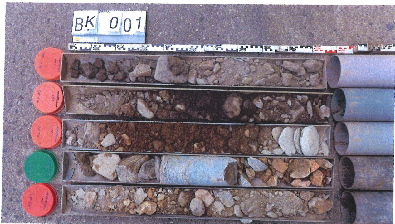
Bild 2: BK 1 (Widerlager Heidersdorf) - Bohrmeter 0 bis 5
