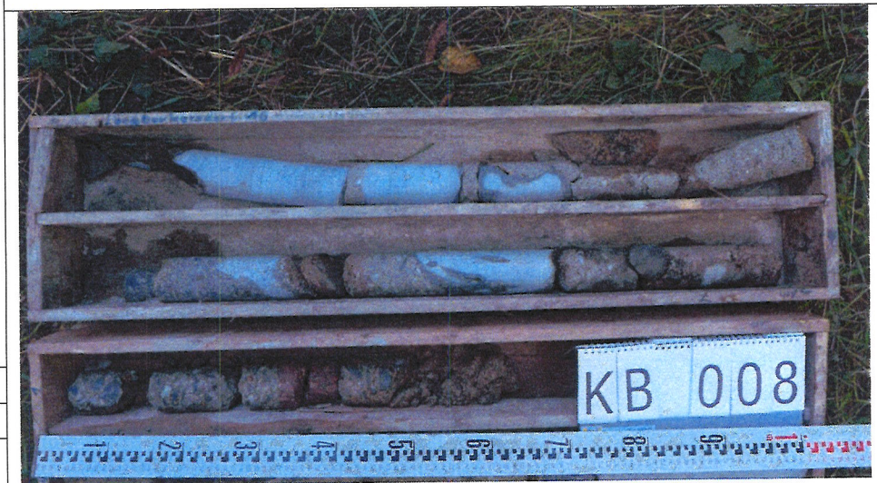
Kernbohrung KB 8 (schräg, 17°) – Gründungstiefe: 501,05 m NHN Bohransatzpunkt: 503,50 m NHN
