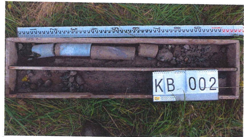
Kernbohrung KB 2 (schräg, 17°) – Bohrtiefe: 1,30 m Bohransatzhöhe: 501,96 m NHN, Gründungstiefe: 500,72 m NHN
