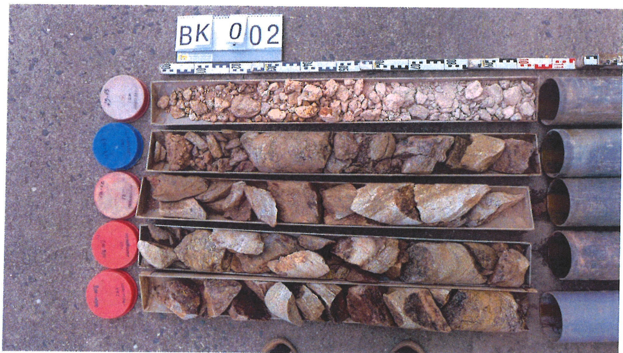
Bild 6: BK 2 (Widerlager Neuhausen) - Bohrmeter 5 bis 10
