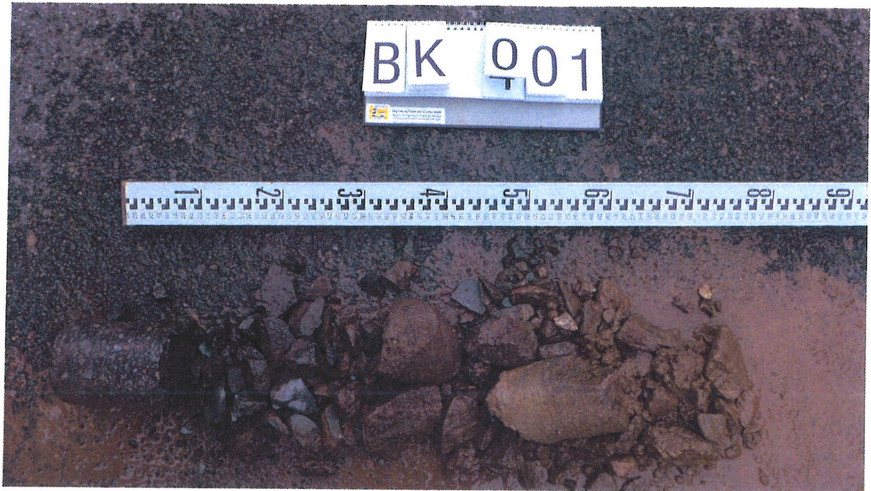
Bild 1: BK 1 (Widerlager Heidersdorf) - Kernbohrung Straßenaufbau
