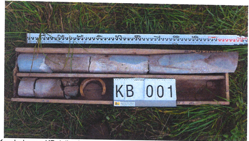
Kernbohrung KB 1 (horizontal) - Widerlagerstärke: 1,38 m in der Endteufe verläuft ein Steinzeugrohr senkrecht von oben nach unten
