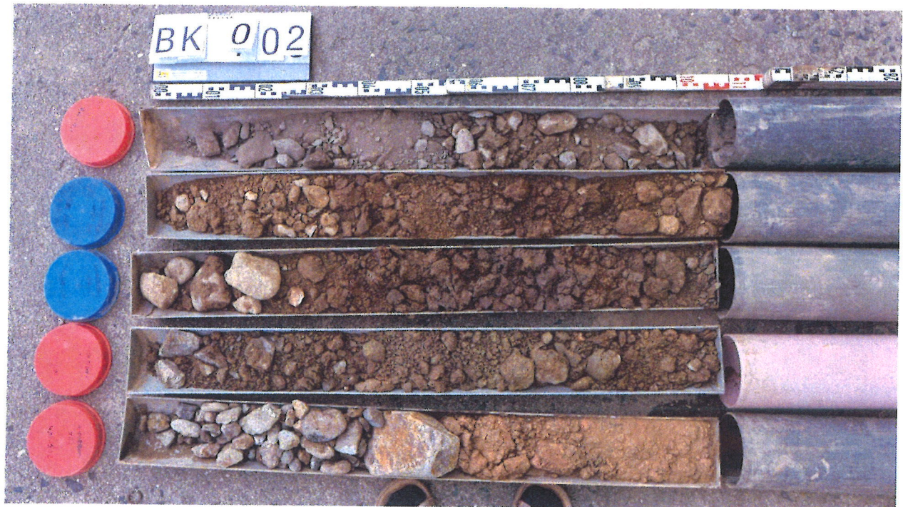
Bild 5: BK 2 (Widerlager Neuhausen) - Bohrmeter 0 bis 5
