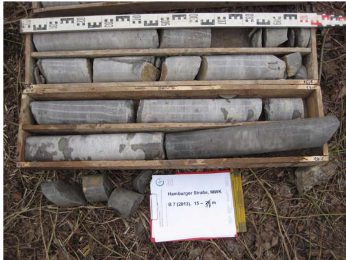
Foto 34: Bohrung B 07/13, Bohrkern 15 – 18 m (v. o. n. u.)
