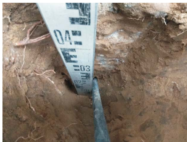
Bild 2: Schurf 29 mit erkennbarer Gründungssohle
