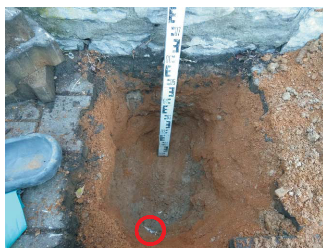
Bild 2: Schurf 14 mit Betonsohle und erkennbarer Leitung
