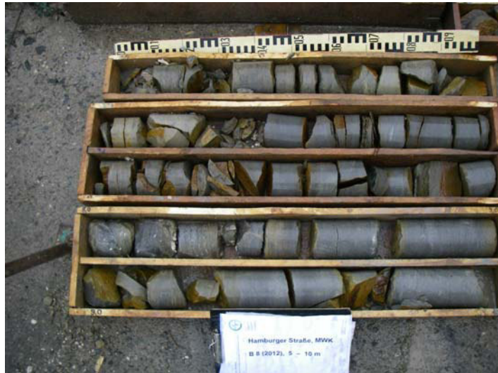
Foto 37: Bohrung B 08/12, Bohrkern 5 – 10 m (v. o. n. u.)
