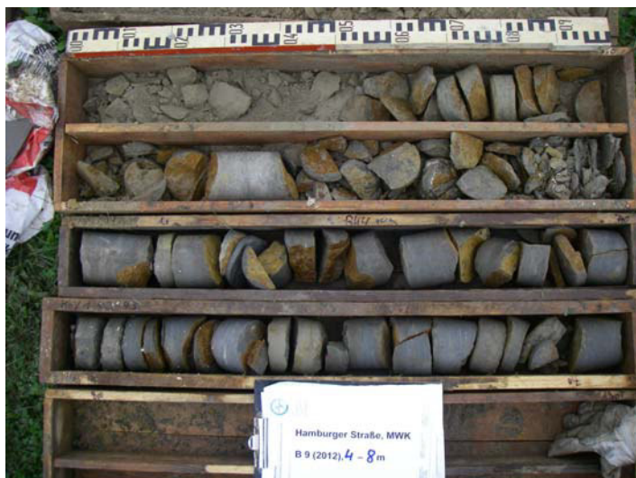
Foto 41: Bohrung B 09/12, Bohrkern 4 – 8 m (v. o. n. u.)
