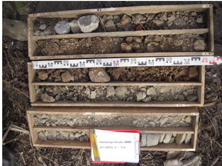
Foto 31: Bohrung B 07/13, Bohrkern 0 – 5 m (v. o. n. u.)
