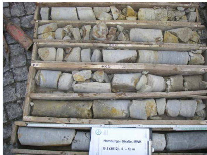
Foto 08: Bohrung B 02/12, Bohrkern 5 – 10 m (v. o. n. u.)
