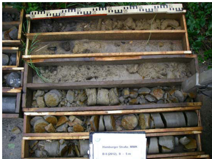
Foto 36: Bohrung B 08/12, Bohrkern 0 – 5 m (v. o. n. u.)
