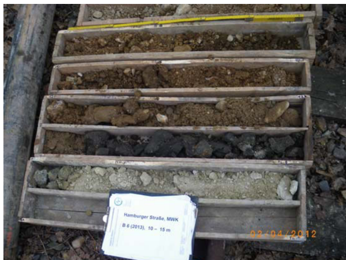
Foto 26: Bohrung B 06/13, Bohrkern 10 – 15 m (v. o. n. u.)
