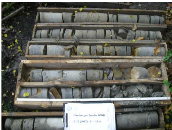
Foto 55: Bohrung B 12/12, Bohrkern 5 – 10 m (v. o. n. u.)
