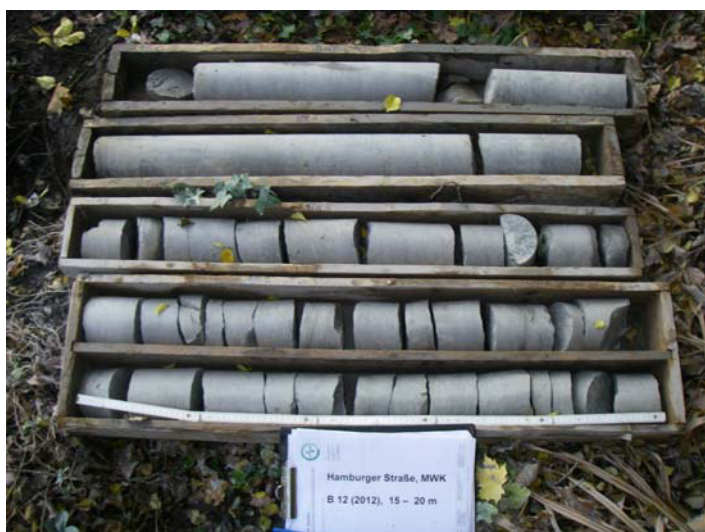
Foto 57: Bohrung B 12/12, Bohrkern 15 – 20 m (v. o. n. u.)
