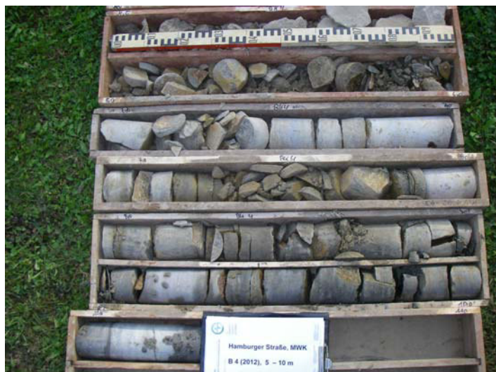
Foto 17: Bohrung B 04/12, Bohrkern 5 – 10 m (v. o. n. u.)
