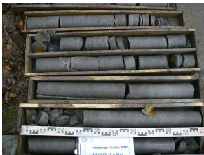
Foto 21: Bohrung B 05/12, Bohrkern 5 – 10 m (v. o. n. u.)
