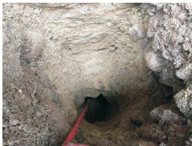
Bild 2: Schurf 20b mit durch Schlitzsonde (im Bild Pin) ermittelter Gründungsohle
