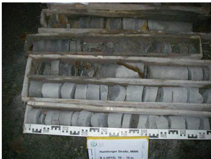
Foto 14: Bohrung B 03/12, Bohrkern 10 – 15 m (v. o. n. u.)
