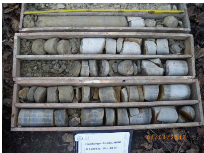
Foto 27: Bohrung B 06/13, Bohrkern 15 – 20 m (v. o. n. u.)
