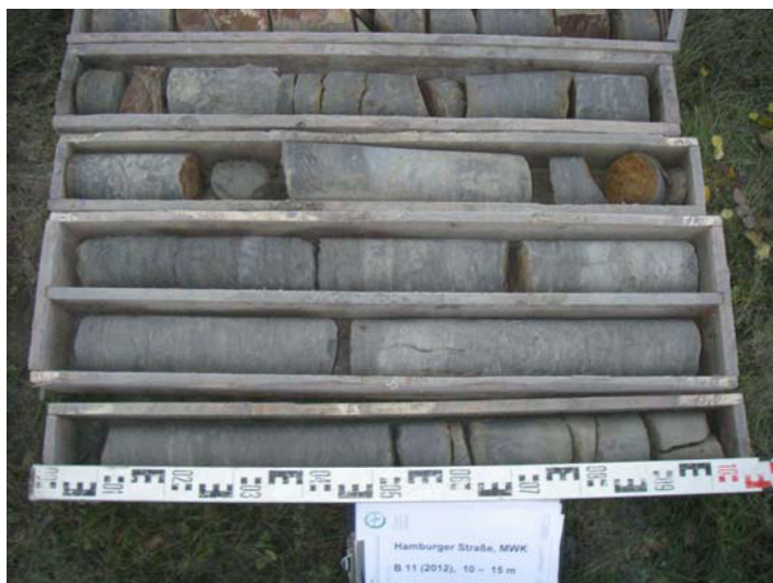
Foto 52: Bohrung B 11/12, Bohrkern 10 – 15 m (v. o. n. u.)
