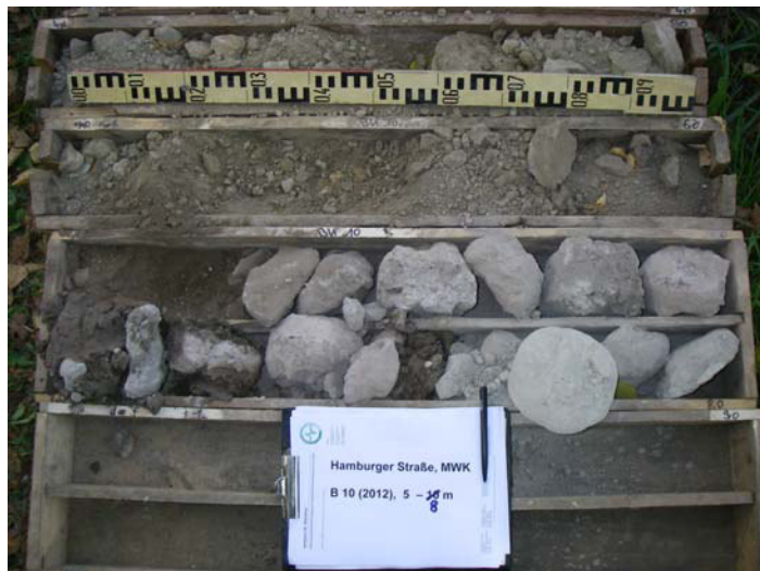
Foto 44: Bohrung B 10/12, Bohrkern 5 – 8 m (v. o. n. u.)
