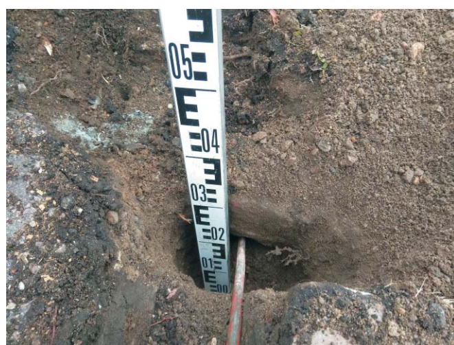
Bild 2: Schurf 24 mit erkennbarer Gründungssohle
