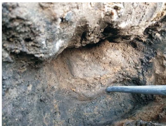
Bild 2: Schurf 5 mit Unterkante Beton und unterlagernden Plänerlagen (Schlitzsonde schräg unter Plänerlagen geschlagen)
