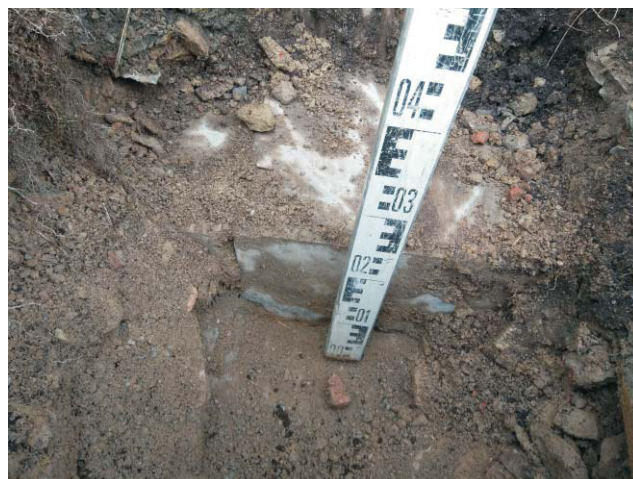
Bild 2: Schurf 25 mit Beton in Schurfsohle
