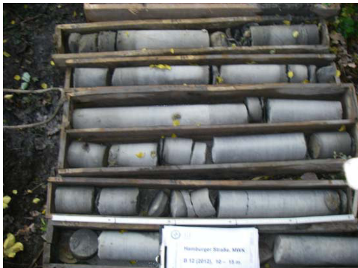
Foto 56: Bohrung B 12/12, Bohrkern 10 – 15 m (v. o. n. u.)
