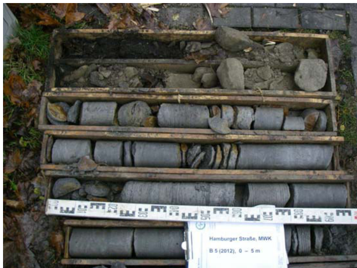
Foto 20: Bohrung B 05/12, Bohrkern 0 – 5 m (v. o. n. u.)
