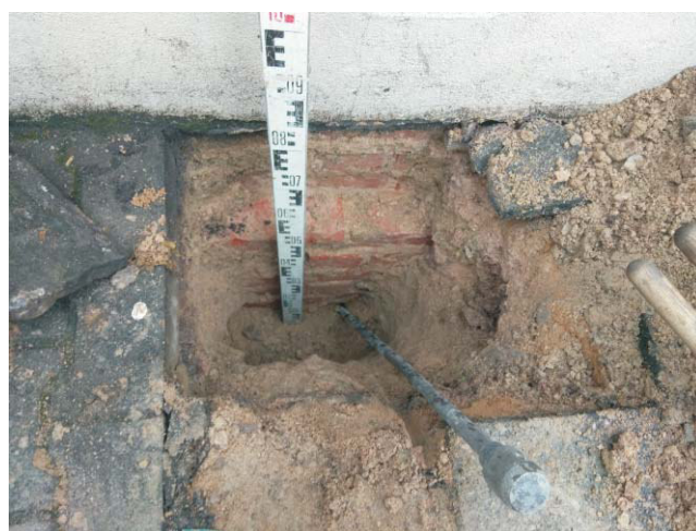
Bild 2: Schurf 21 mit durch Schlitzsonde ermittelter Gründungssohle (Steine als Schachthindernis in Schurfsohle)
