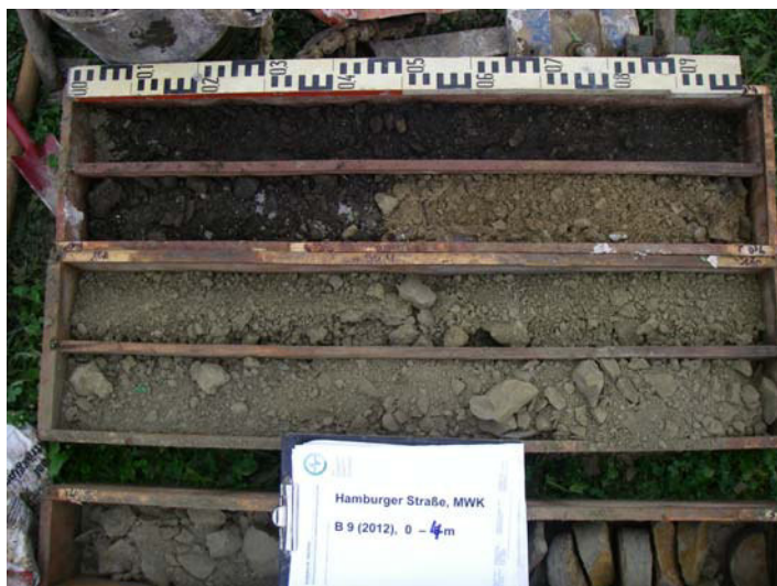
Foto 40: Bohrung B 09/12, Bohrkern 0 – 4 m (v. o. n. u.)
