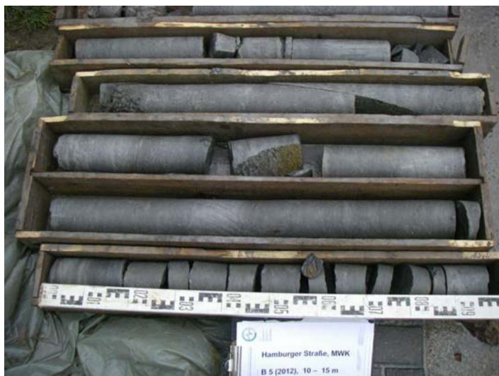
Foto 22: Bohrung B 05/12, Bohrkern 10 – 15 m (v. o. n. u.)
