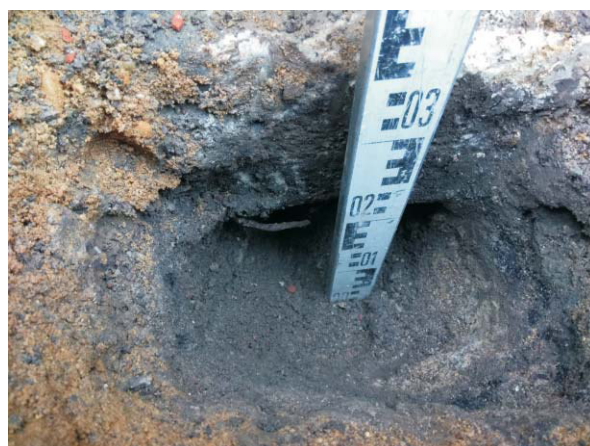
Bild 2: Schurf 6 mit Unterkante Beton und unterlagernder Auffüllung (helles Mat. rechts unten im Bild = Zersatzmaterial Pläner)
