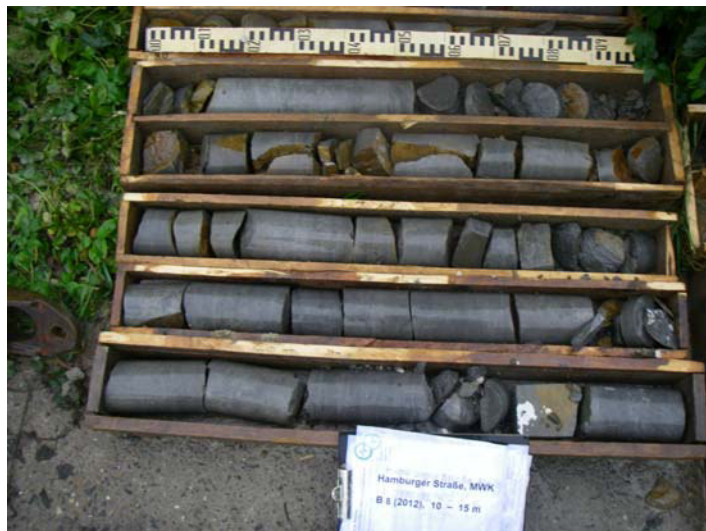
Foto 38: Bohrung B 08/12, Bohrkern 10 – 15 m (v. o. n. u.)
