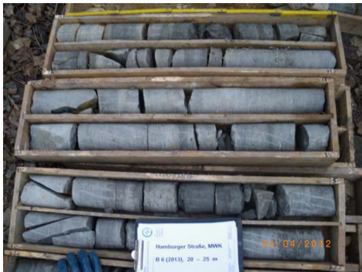
Foto 28: Bohrung B 06/13, Bohrkern 20 – 25 m (v. o. n. u.)
