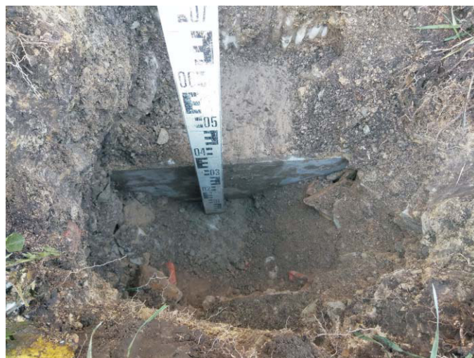
Bild 2: Schurf 26 mit Beton in Schurfsohle
