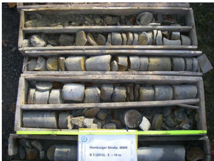
Foto 13: Bohrung B 03/12, Bohrkern 5 – 10 m (v. o. n. u.)
