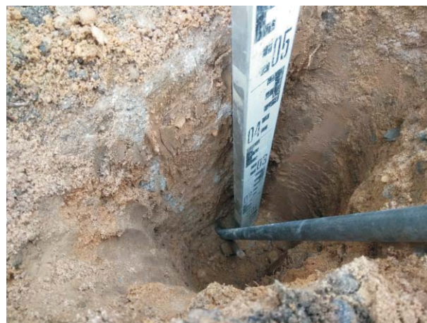
Bild 2: Schurf 30 mit durch Schlitzsonde erkundeter Gründungssohle
