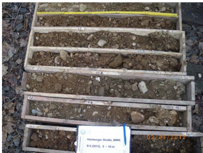
Foto 25: Bohrung B 06/13, Bohrkern 5 – 10 m (v. o. n. u.)
