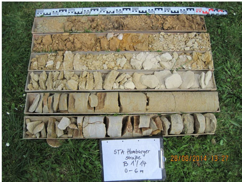
Foto 1: Bohrung B 1/2014, Bohrkern 0 – 6 m
