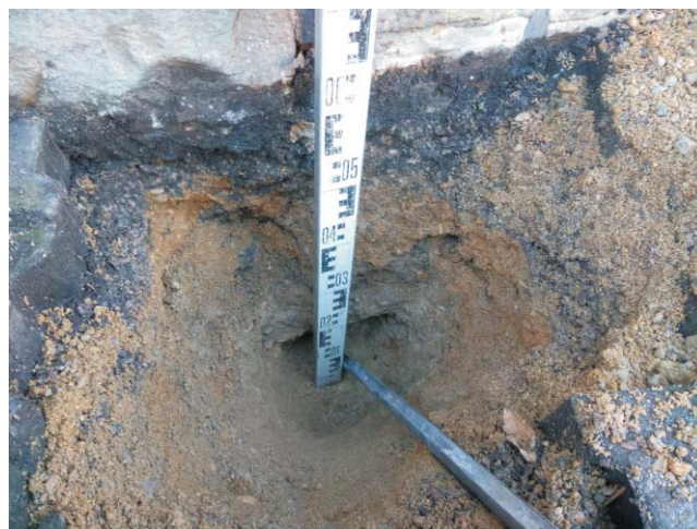
Bild 2: Schurf 7 mit durch Schlitzsonde ermittelter Gründungssohle
