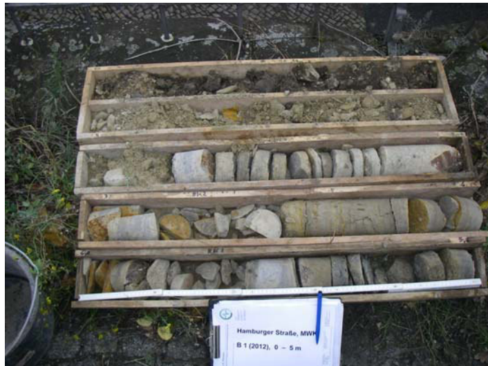
Foto 02: Bohrung B 01/12, Bohrkern 0 – 5 m (v. o. n. u.)
