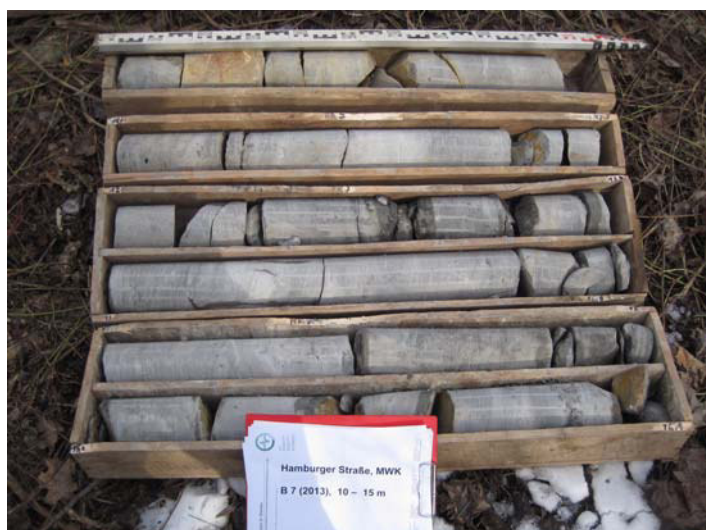
Foto 33: Bohrung B 07/13, Bohrkern 10 – 15 m (v. o. n. u.)
