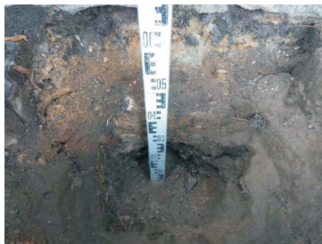
Bild 2: Schurf 13 mit erkennbarer Gründungssohle und unterlagernder Schotterauffüllung
