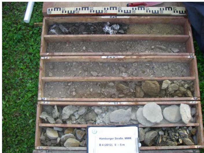
Foto 16: Bohrung B 04/12, Bohrkern 0 – 5 m (v. o. n. u.)
