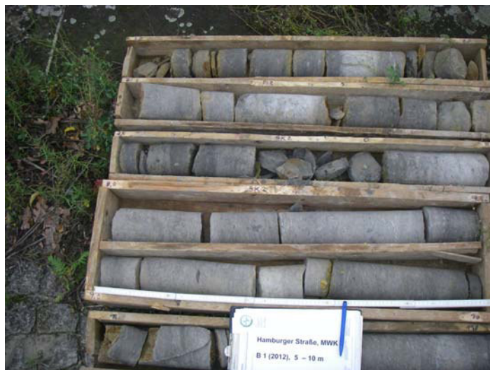
Foto 03: Bohrung B 01/12, Bohrkern 5 – 10 m (v. o. n. u.)
