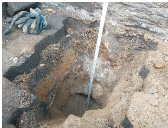
Bild 2: Schurf 1 mit erkennbarer Gründungssohle
