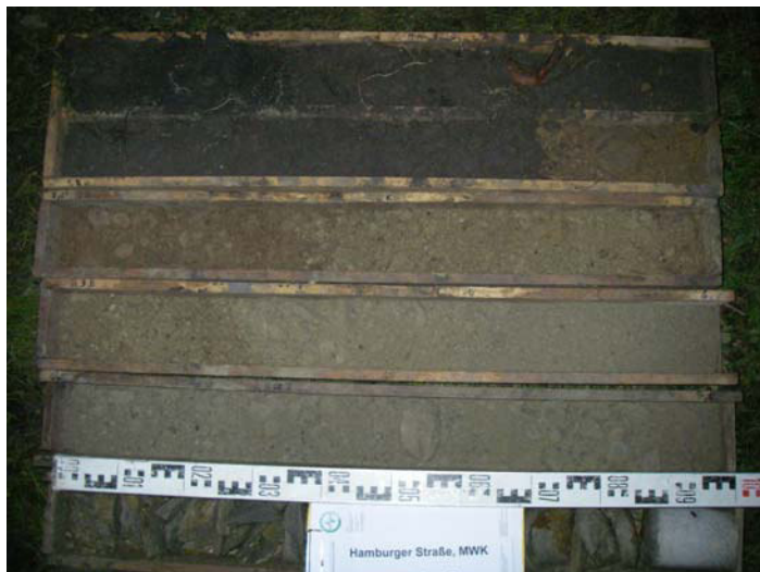
Foto 50: Bohrung B 11/12, Bohrkern 0 – 5 m (v. o. n. u.)
