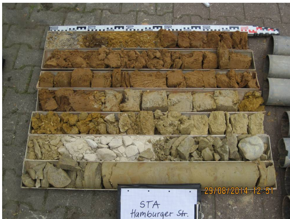
Foto 2: Bohrung B 2/2014, Bohrkern 0 – 7 m
