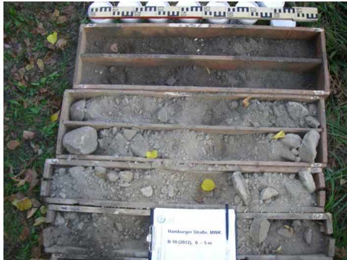
Foto 43: Bohrung B 10/12, Bohrkern 0 – 5 m (v. o. n. u.)
