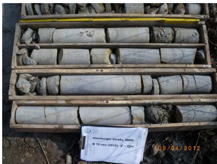
Foto 48: Bohrung B 10/13neu, Bohrkern 8 – 12 m (v. o. n. u.)
