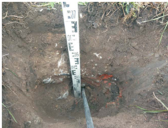
Bild 2: Schurf Werbeschild mit erkennbarer Gründungssohle
