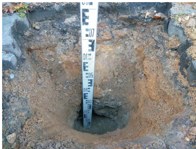
Bild 2: Schurf 8 mit erkennbarer Gründungssohle
