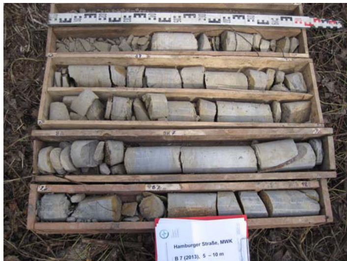
Foto 32: Bohrung B 07/13, Bohrkern 5 – 10 m (v. o. n. u.)
