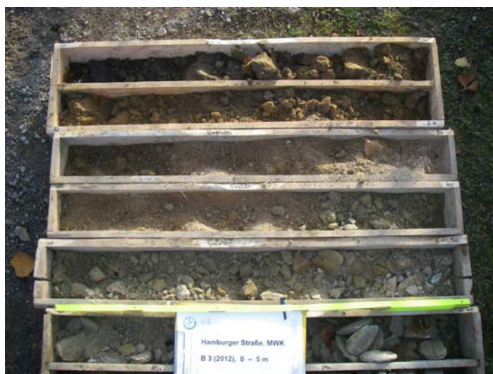
Foto 12: Bohrung B 03/12, Bohrkern 0 – 5 m (v. o. n. u.)
