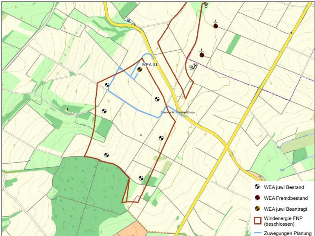
Figure 3 : Planification de l'accès à WEA01, sans échelle.
