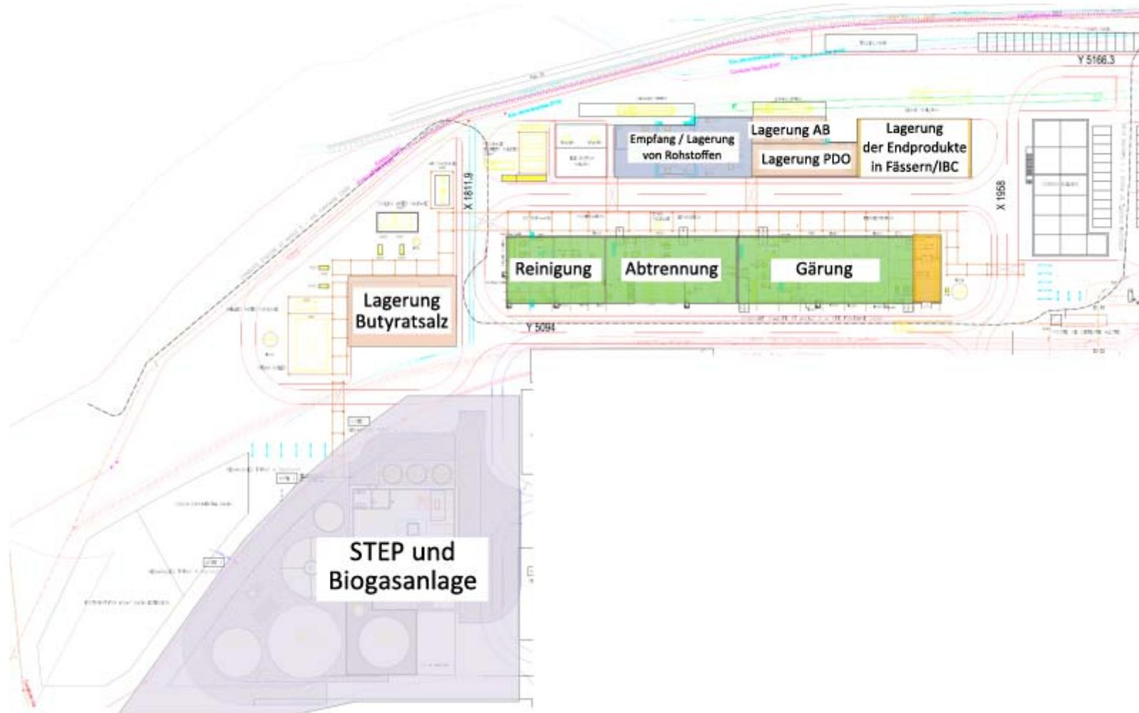
Abbildung2: Standortlayout der zweckmäßigen Systeme des Projekts
