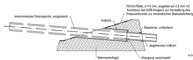
**Detail 3: Rohraufleger Sickerwasserdrainageleitung**
