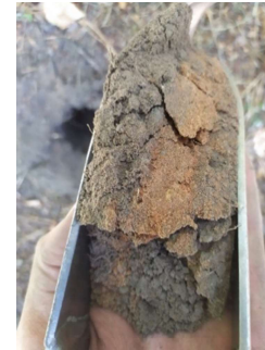
Photo 26 : Horizon de surface sablo-limoneux (limons et sables gréseux rosâtres) d'un Anthroposol transformé (Rainette, 2020 – photo prise sur site)
