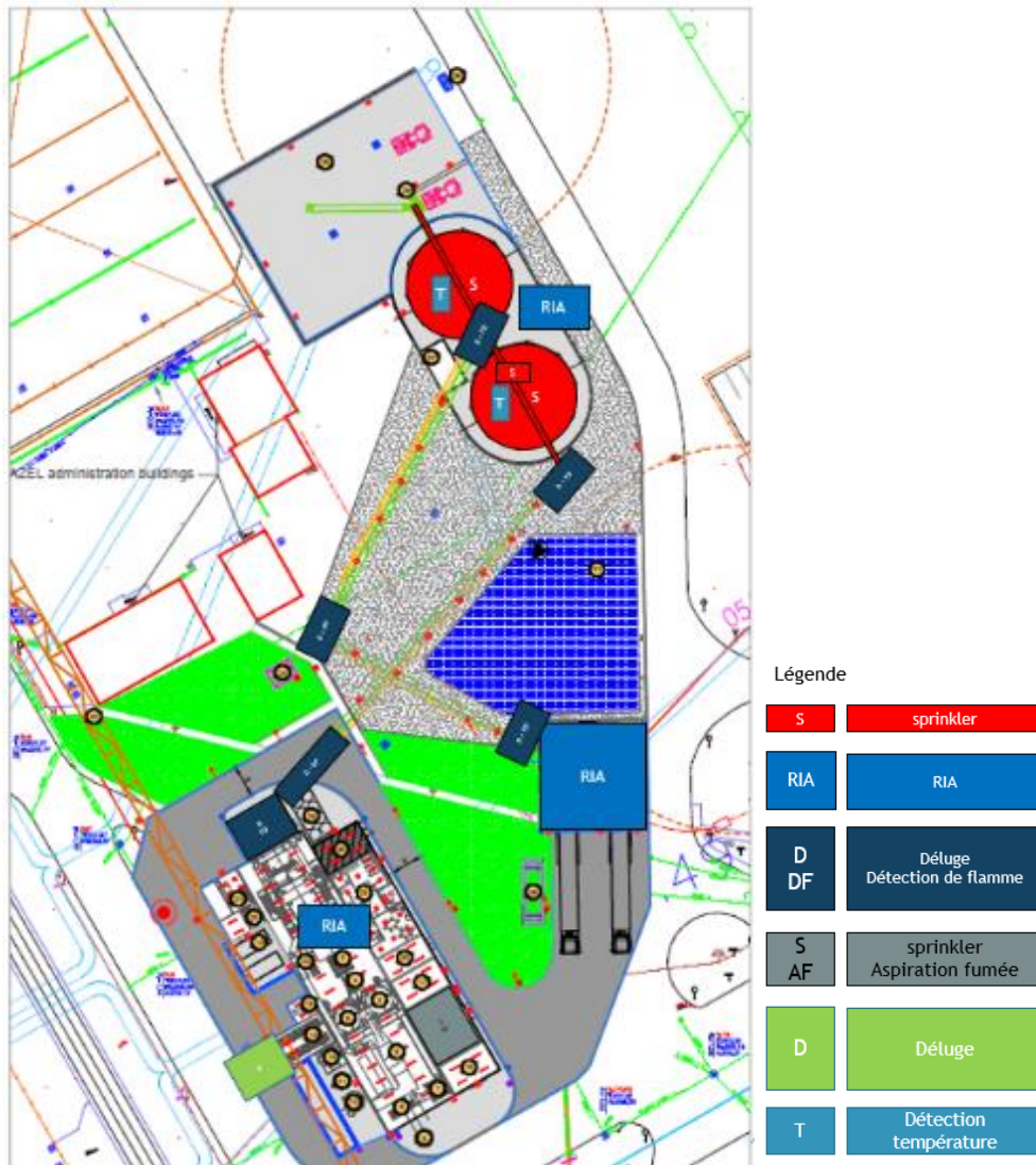
Figure 41 : localisation des moyens de lutte contre l'incendie
