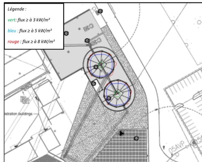
Figure 12 : Résultats de la modélisation incendie dans les silos de bois énergie
