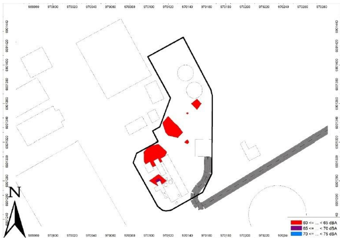
Figure 30 : Carte de bruit zoom sur le projet – État futur – Période nocturne (Source : Venathec, 2021)
