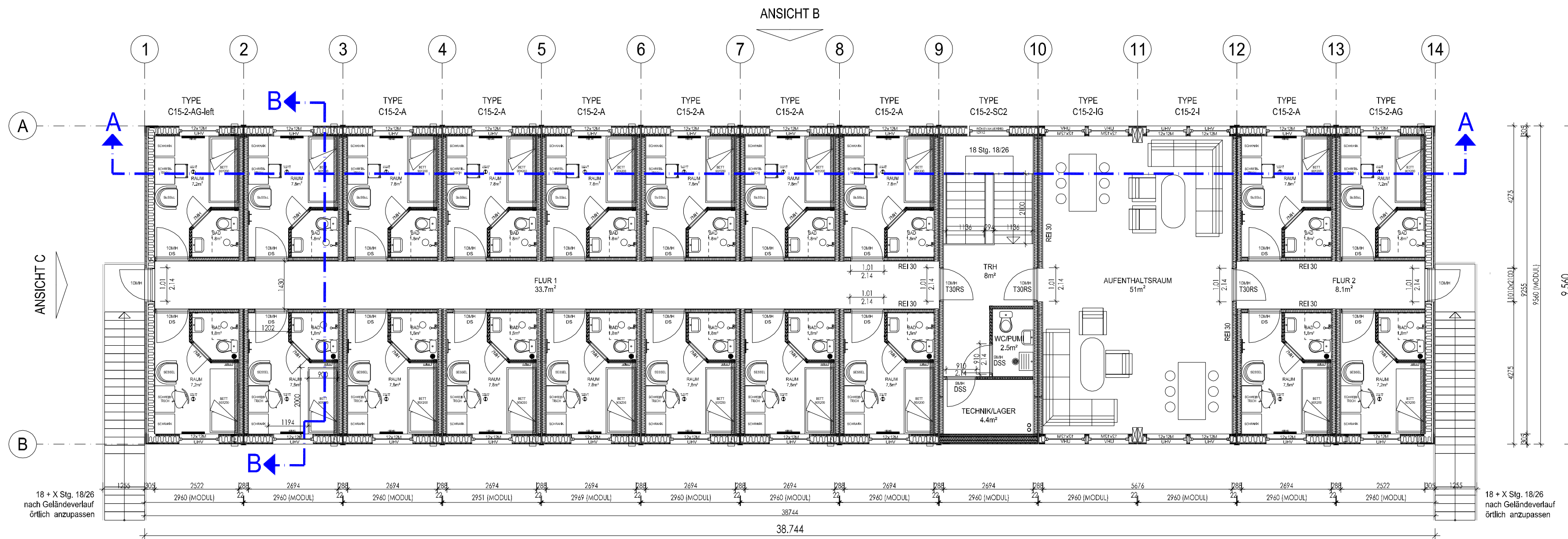
GRUNDRISS OBERGESCHOSS - TYP B 13 Module x 2 Geschosse = 26 Module / Gebäude 20 x 1-Bett-Zimmer im OG
