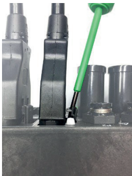
Lösen Sie die Sicherheitskralle für den 230V-Stecker
