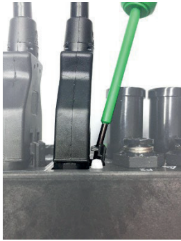
Lösen Sie die Sicherheitskralle für den 230V-Stecker
