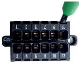
Kabel 230V Ausgang mit Stecker für UV-Modul & Tauchpumpe
