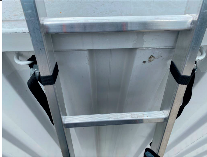
Abbildung 11: Leiter auf der Rückseite des Containers Laschen an Ösen
