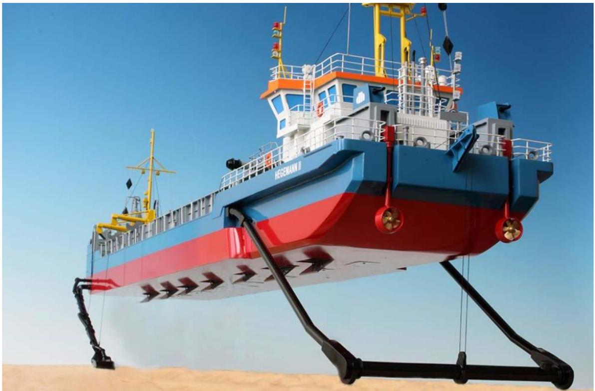
**Abb. 3:** Hopperbagger mit Bodenklappen.
