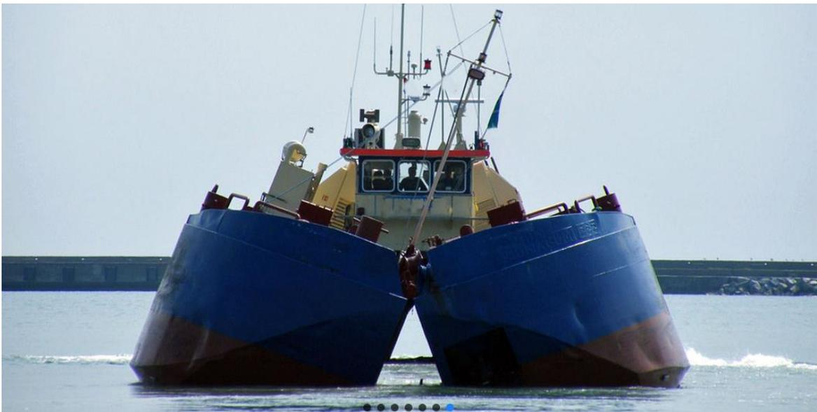
**Abb. 2:** Darstellung der Funktionsweise eines Split-Hopperbaggers.
