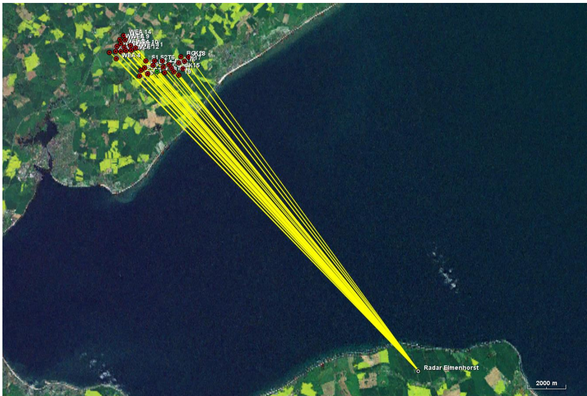
Abbildung 9: Luftaufnahme des Windparks Körnick/Schashagen mit der geplanten Windenergieanlage (grün), sowie der relevanten Vorbelastung (rot). Die Einstrahlungsrichtungen bzgl. der Radaranlage Elmenhorst sind gelb dargestellt. Aus Gründen der Übersichtlichkeit sind nicht alle Bezeichnungen der WEA dargestellt.
