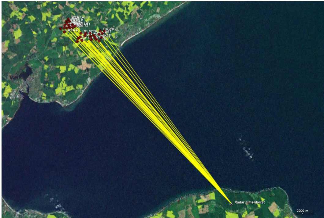
Abbildung 2: Luftaufnahme des Windparks Körnick/Schashagen mit der geplanten Windenergieanlage (grün), sowie der relevanten Vorbelastung (rot). Die Einstrahlungsrichtungen bzgl. der Radaranlage Elmenhorst sind gelb dargestellt. Aus Gründen der Übersichtlichkeit sind nicht alle Bezeichnungen der WEA dargestellt.
