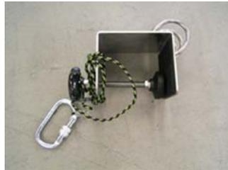
Abb. 21 U-förmiger Kantenschutz
