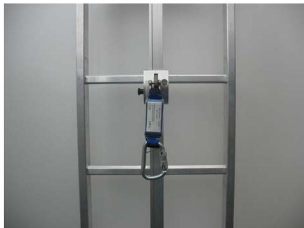
Abb. 8 Fallschutzläufer
