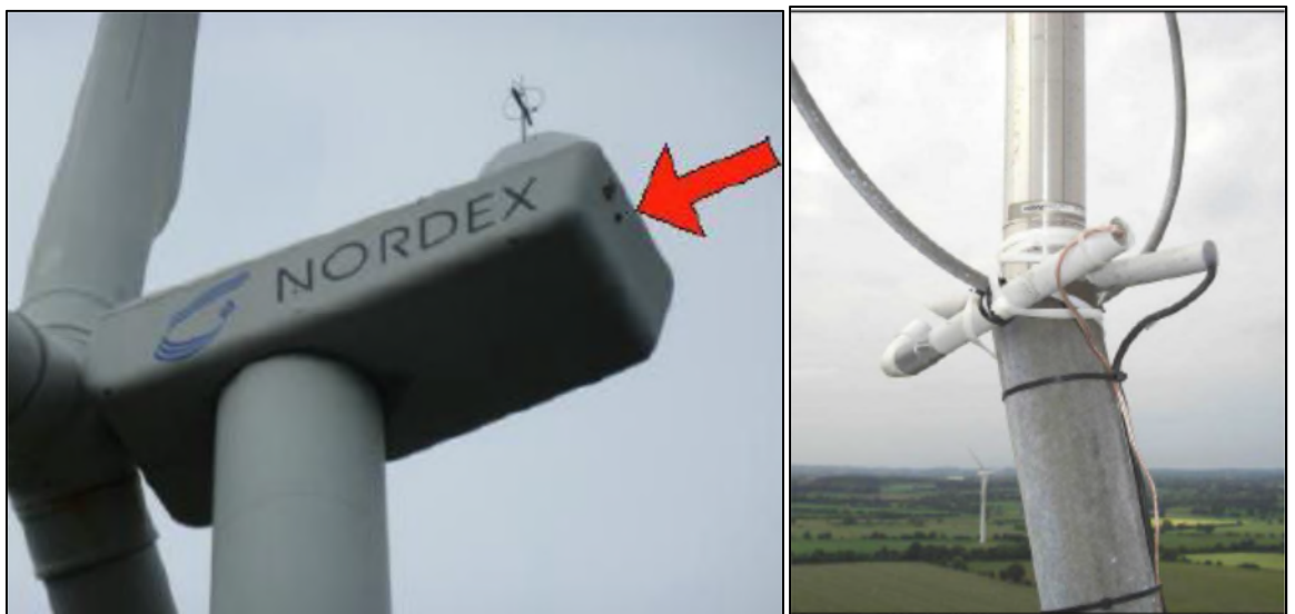
Abb. 2-2 Position des EcoObs-Mikrofons in der Gondel einer Nordex-Anlage (GGV, WP Krumbek, links), Installation des Mikrofons des Systems Avisoft Knowles FG, verwendet von GfN (WP Schashagen.)
