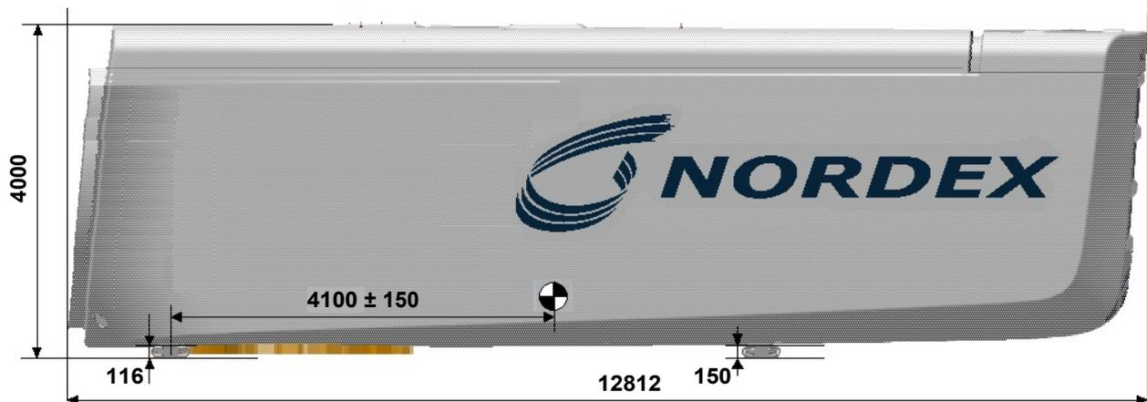
Abb. 1 Maschinenhaus (Ansicht von links) mit Transportfüßen
