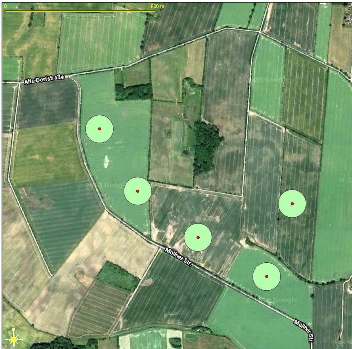
Karte 2: Standorte der geplanten WEA in der Feldflur (Kartenbasis Google Sattelitel Hybrid)
