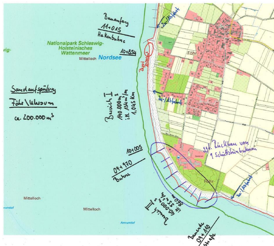
Abb. 2: Lage der aufzuspülenden Strandbereiche im Bereich Utersum / Föhr
