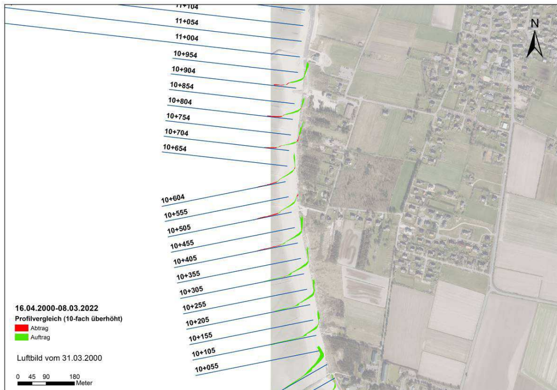
Abbildung 11: Querprofilvergleiche im Bereich Utersum (West) 16.04.2000 – 08.03.2022 (Profile 10-fach überhöht)
