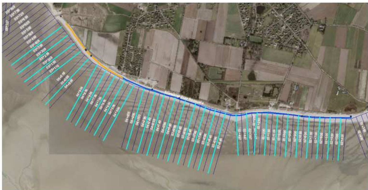
Abbildung 4: Terrestrisch vermessene Profile im Bereich Goting Kliff und Nieblum (Profil 05+409 bis 02+500) in 100 m – Abständen am 09.03.2022
