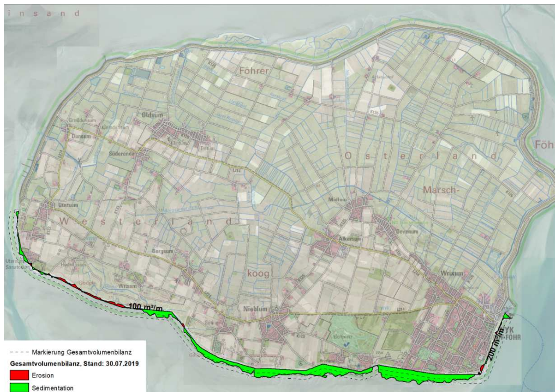
Abbildung 22: Gesamtvolumenbilanz, Stand der Vermessungen: 30.07.2019, bezogen auf den Referenzzustand
