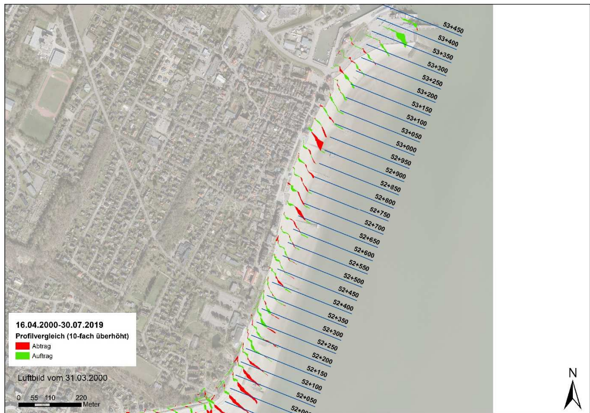
Abbildung 21: Querprofilvergleiche im Bereich Wyk (Oststrand) 16.04.2000 – 30.07.2019 (Profile 10-fach überhöht)
