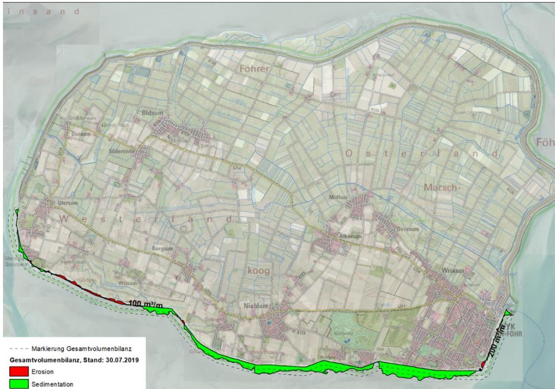
Abbildung 6: Gesamtvolumenbilanz, Stand der Vermessungen: 30.07.2019, bezogen auf den Referenzzustand
