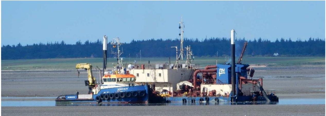
Abb. 14: schwimmende Druckerhöhungsstation
