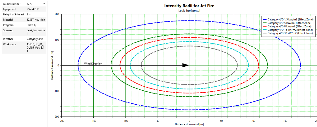
Abbildung 3-6: Szenario 2: Verlauf der Wärmestrahlung eines Freistrahbrandes in 2 m Höhe
