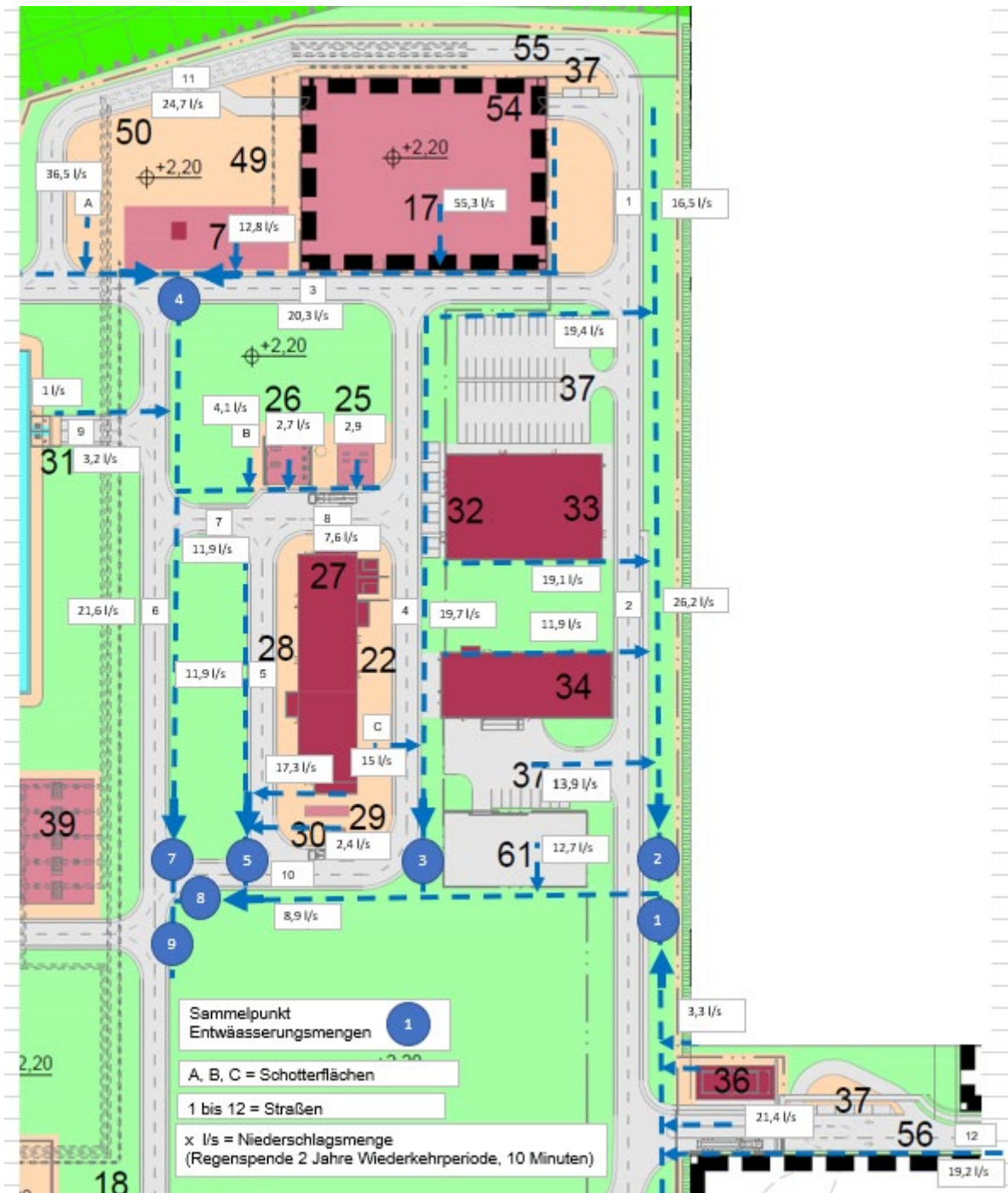
Abb. 5-3: Entwässerungsmengen im Gebäudebereich
