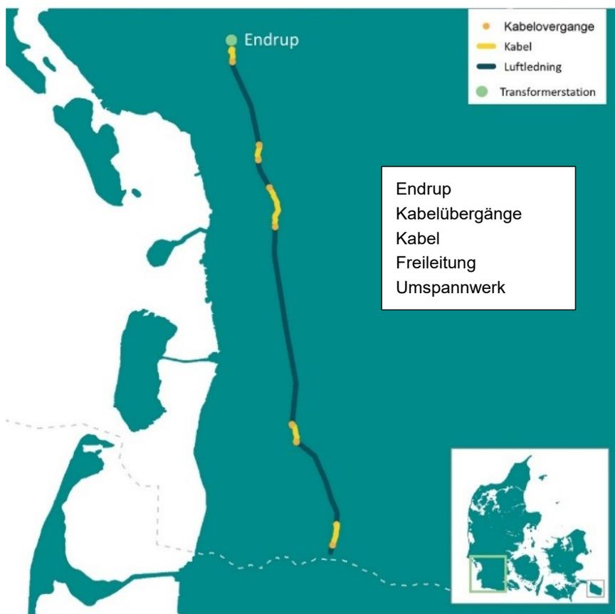
Abbildung 1 – Lage der neuen 400-kV-Leitungstrasse mit Angabe der Erdkabelabschnitte, der Kabelübergänge und des Hochspannungsumspannwerks Endrup, an das das Projekt angeschlossen wird. Die Änderungen am Hochspannungsumspannwerk Endrup werden im Umweltverträglichkeitsbericht für die Verstärkung des Stromnetzes Endrup-Idomlund hervorgehoben.
