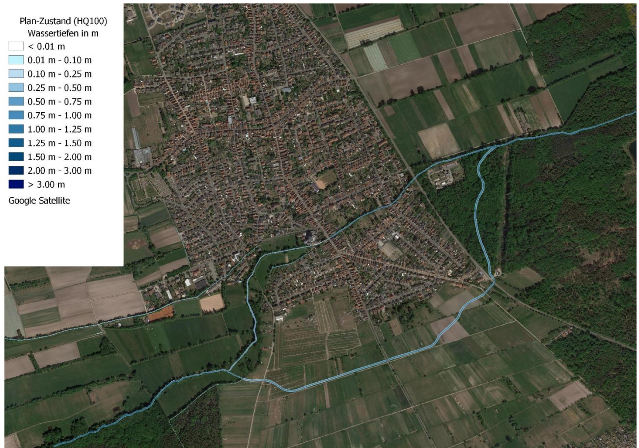
Abbildung 19: Wassertiefen und Überflutungsflächen im Plan-Zustand (HQ 100 )
