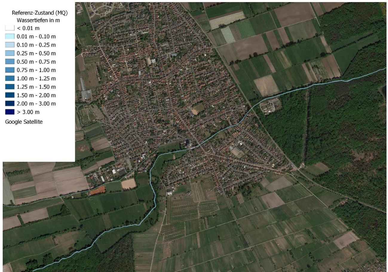
Abbildung 9: Wassertiefen und Überflutungsflächen im Referenz-Zustand (MQ)
