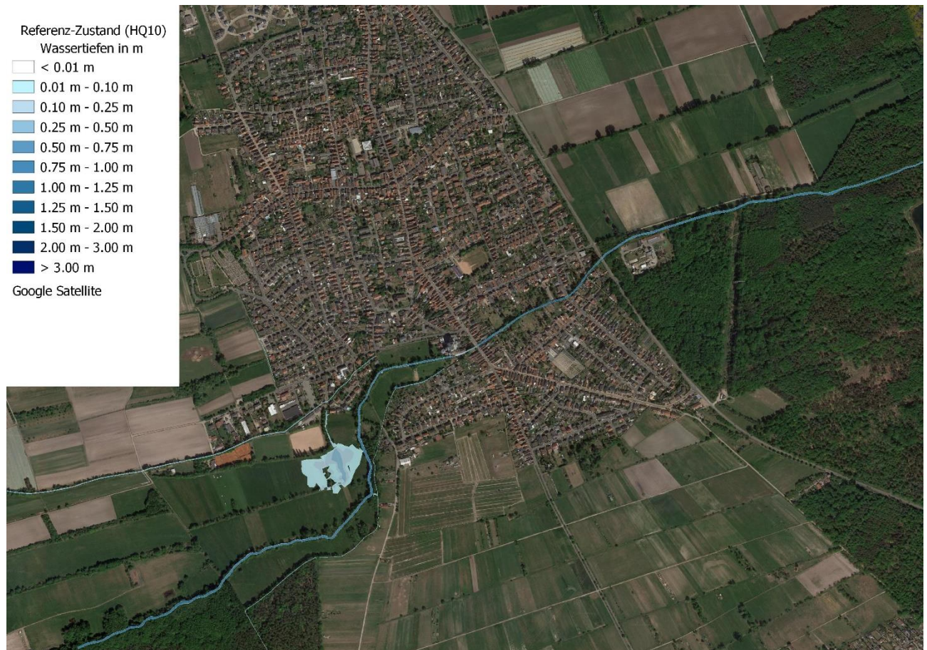
Abbildung 10: Wassertiefen und Überflutungsflächen im Referenz-Zustand (HQ 10 )
