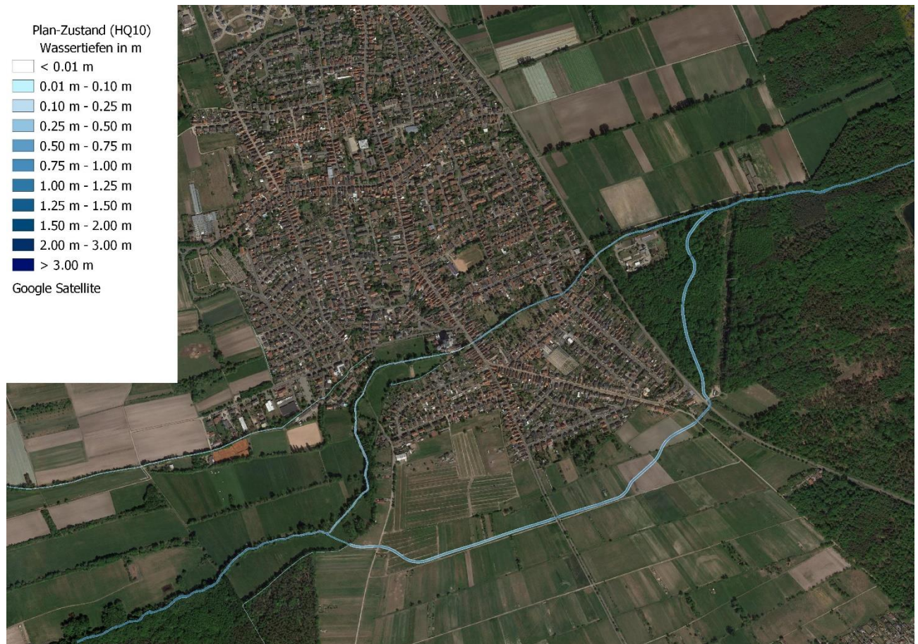
Abbildung 18: Wassertiefen und Überflutungsflächen im Plan-Zustand (HQ 10 )
