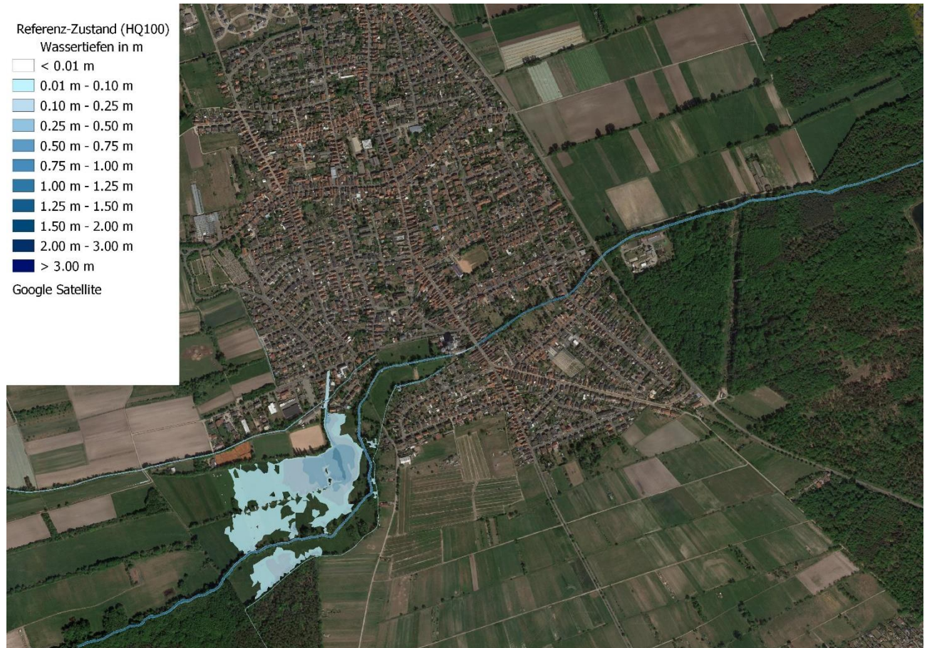
Abbildung 11: Wassertiefen und Überflutungsflächen im Referenz-Zustand (HQ 100 )
