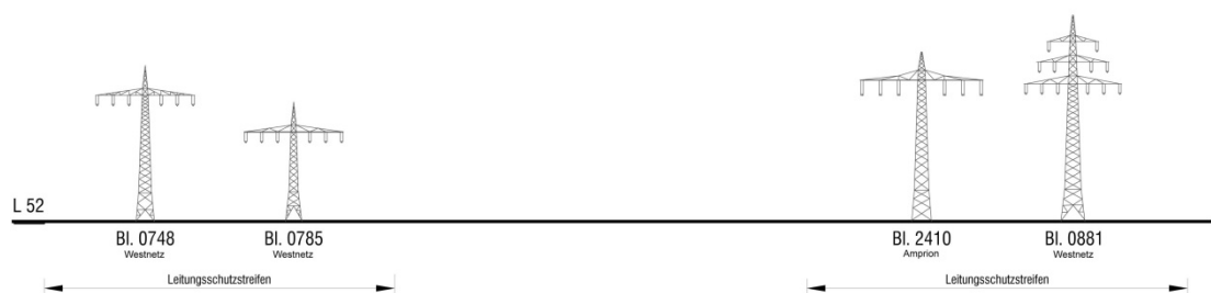
Abb. 22: Schematischer Ansichtsquerschnitt des vorhandenen Trassenbandes im Teilabschnitt Pkt. Wittlich - UA Wengerohr (ca. 0,7 km)
