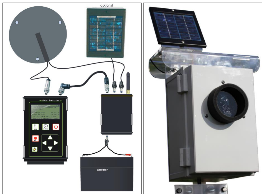
Abbildung 2.1: Außenansicht der Boxerweiterung mit Grenzflächenmikrofon und Solarpanel (links) und schematischer Aufbau des verwendeten batcorder-Messsystems inkl. Box-Erweiterung (rechts) (Quelle: ecoObs GmbH)
