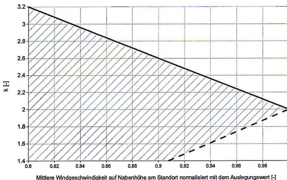
Abbildung 2.1.1: Mögliche Kombinationen von normierter Windgeschwindigkeit und Formparameter k der Weibull-Verteilung (schraffierter Bereich).
