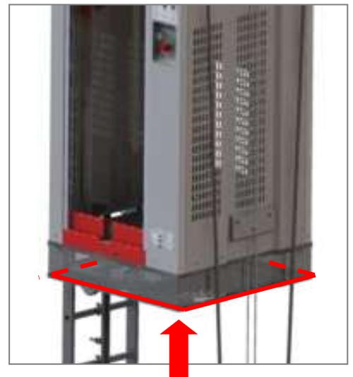
(\*) das System ermöglicht 1,5 Sekunden lang eine tatsächliche Bewegung. Wenn eine Person den Aufzug 1 Sekunde lang aufwärts fahren und dann anhalten würde, wird das System immer noch erlauben, weitere 0,5 Sekunden abwärts zu fahren.
