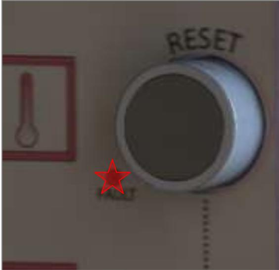
Für den Fall, dass der Aufzug in den FEHLERMODUS geht, wird die Fehler-LED auf dem Display zu blinken anfangen. Die LED wird mehrere Male blinken und dann pausieren. Durch Zählen der Anzahl der Blinkvorgänge kann der Fehler ermittelt werden.
