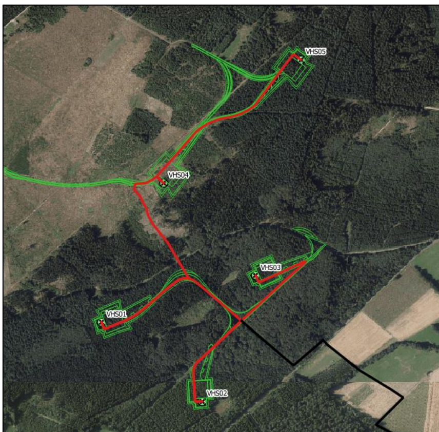
Abbildung 6: Übersicht der geplanten internen Kabeltrasse (rot) im Bereich der geplanten Eingriffsflächen (grün umrandet) (Kartengrundlage: LVermGeoRP 2016)
