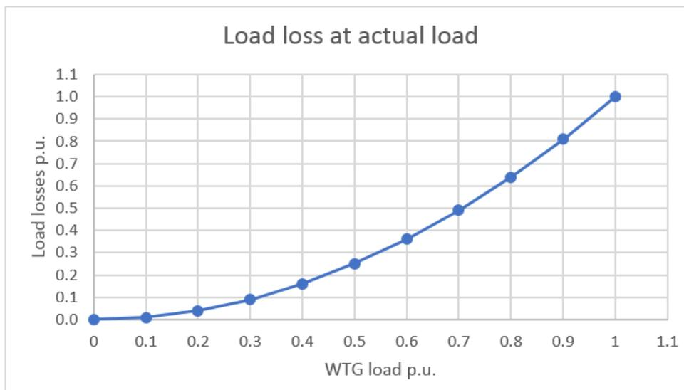
Abbildung 4-2- Transformatorlastverluste – Skalierung.
