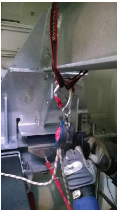
Abbildung 5.23: Am internen Ausleger befestigte Abstiegsvorrichtung
