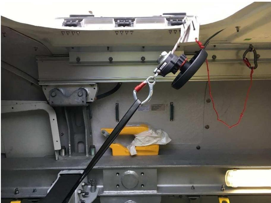
**Abbildung 5.16: Abstiegsvorrichtung und Schlinge um den Querträger**
