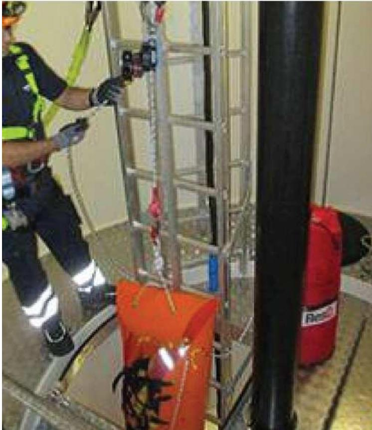
Abbildung 5.25: Absenken der verletzten Person mithilfe der Abstiegsvorrichtung
