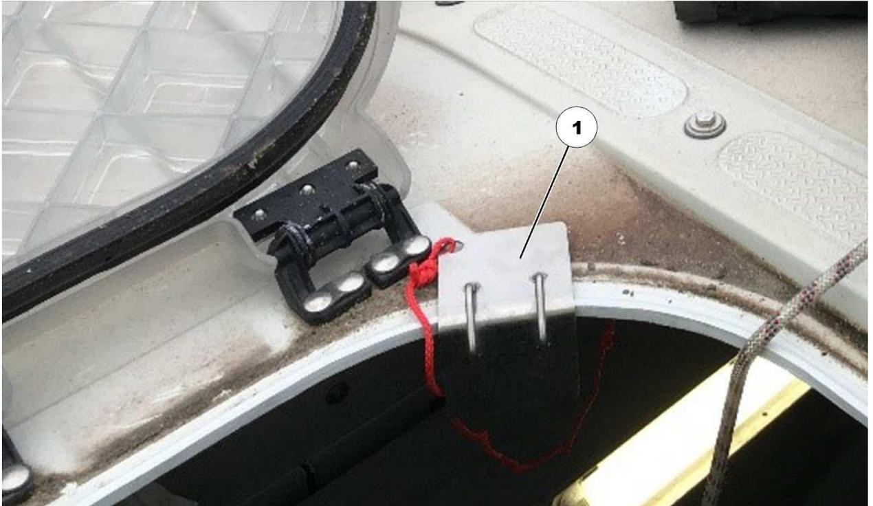
**Abbildung 5.15: Kantenschutzvorrichtung am Rand der Dachluke**
