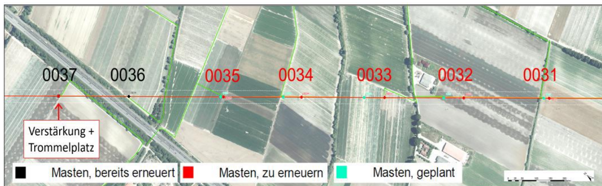
Abbildung 9: Übersicht der Maststandorte im Bereich der Masten 0031 - 0037
