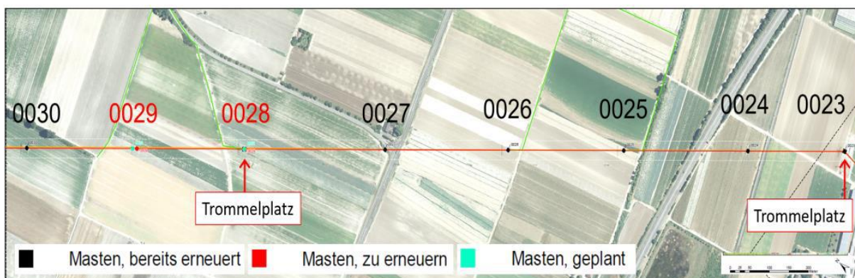
Abbildung 8: Übersicht der Maststandorte im Bereich der Masten 0023 - 0030
