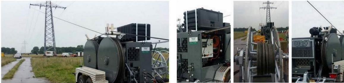
Abbildung 6: Beispielfoto einer Zugmaschine mit Kabeltrommel
