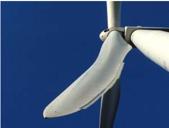
Abb. 1: Serrations (gezackte Blatthinterkanten) an einer WEA
